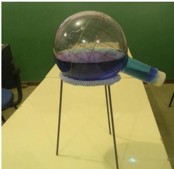
Nessa disposição, o plano formado pela superfície da água no interior da Esfera de vidro caracteriza o plano do horizonte de um observador em algum lugar da Terra cuja latitude é definida pela inclinação do eixo de rotação do balão em relação à horizontal da sala, conforme retomaremos adiante.
