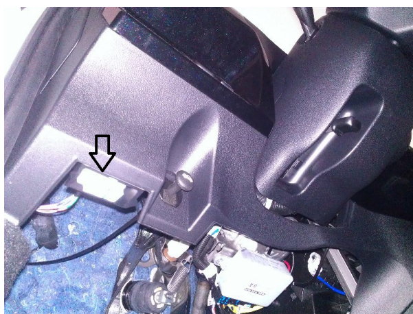
Figura 2.1: Conector OBD-II em um veículo Toyota Etios 2015
