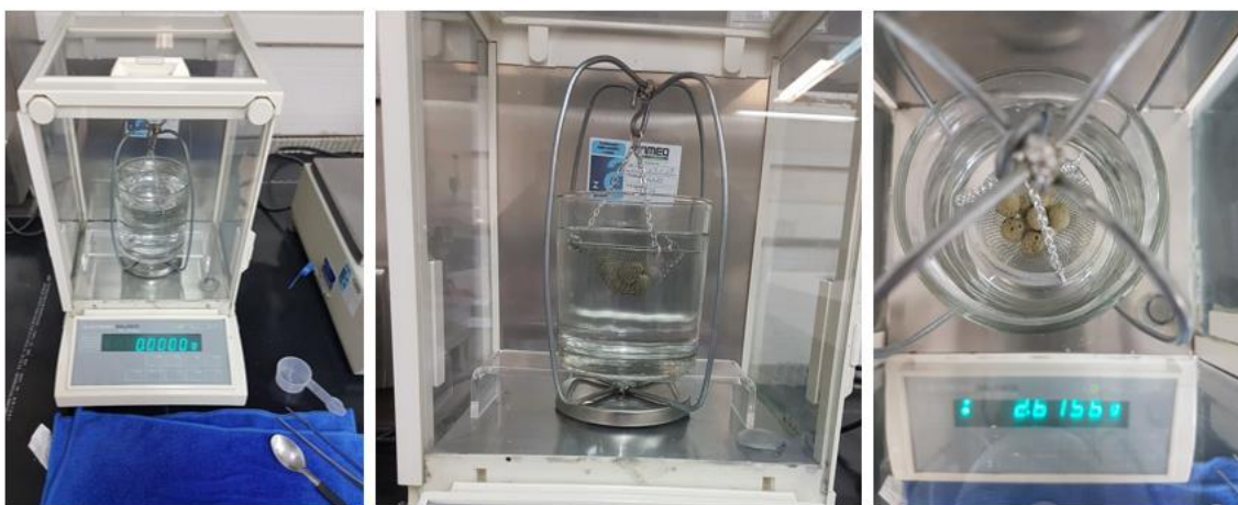
Figura 3.14 - Aparato de adaptação de balança de precisão para realizar medida submersa nos ensaios de massa específica aparente dos grãos e absorção de água.
