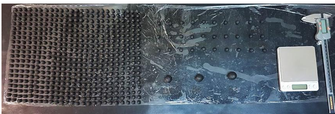
Figura 3.12 - Agregados da mistura RBC-MB-90% em secagem ao ar livre por 24h, balança de precisão de 0,01 g e paquímetro digital de precisão 0,01 mm.
