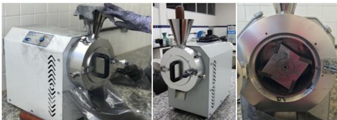
Figura 3.6 - Imagens do moinho de facas utilizado para produção do RBC-MF.
