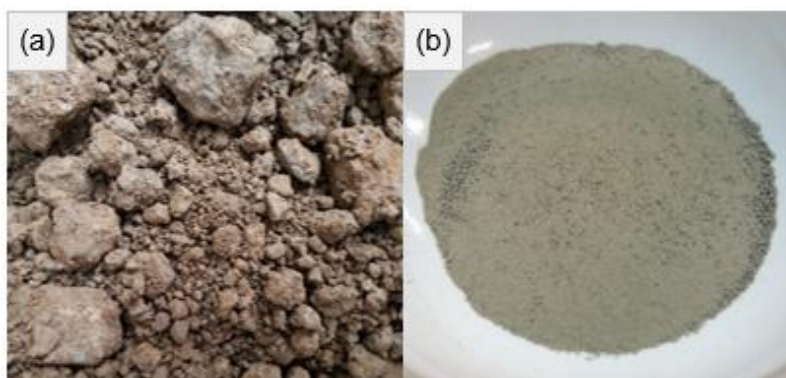
Figura 3.3 - Argila vermelha utilizada na pesquisa (ARG-V). (a) argila úmida, com torrões, recém coletada e (b) argila após beneficiamento.
