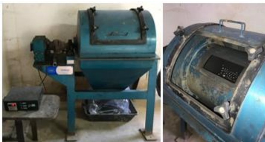
Figura 3.5 - Imagens do moinho de bolas utilizado para produção do RBC-MB.
