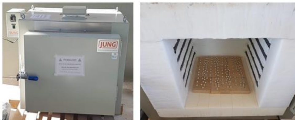
Figura 3.13- Aparência externa da mufla utilizada e detalhe das placas refratárias utilizadas para proteção interna do equipamento.
