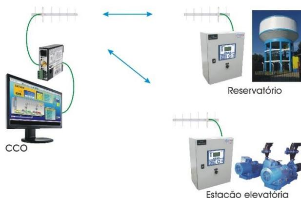
Figura 55 - Esquema funcional do fluxo de dados.
