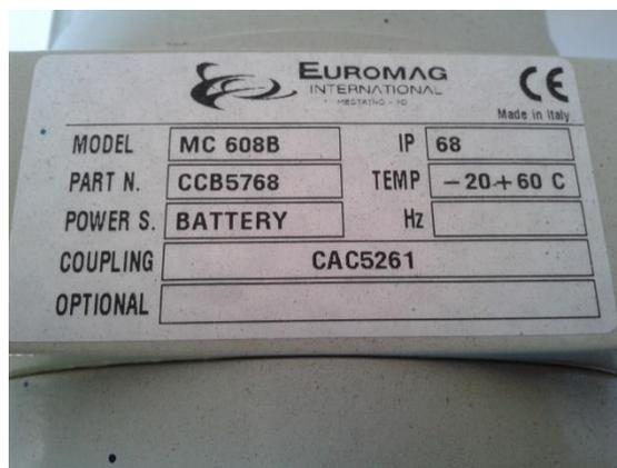
Figura 21 - Placa de identificação do elemento conversor.
