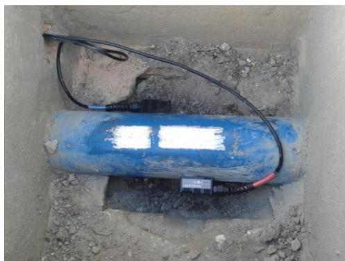
Figura 25 - Sensores instalados com destaque para área sem pintura.
