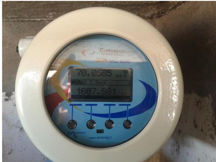
Figura 22 - Display do medidor de vazão.
