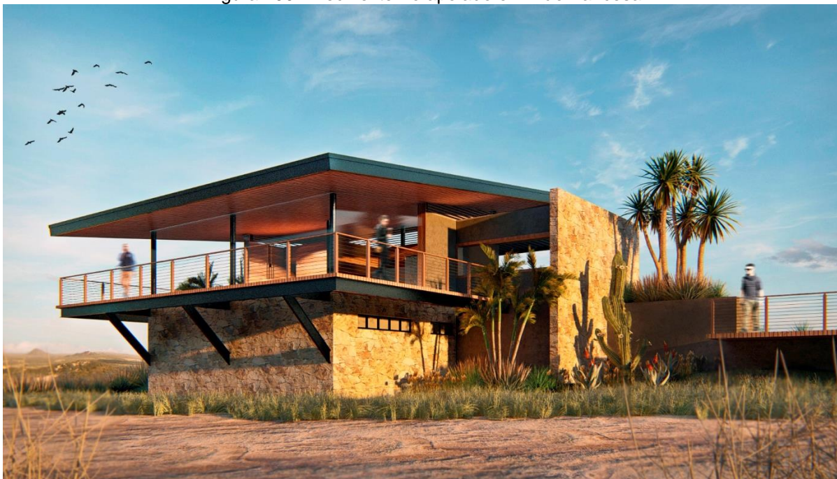
Figura 100 - Deck externo apoiado em mão francesa
