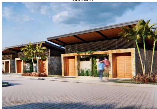
Figura 108 – Volumetria do bangalô com cobertura metálica e cobertura com forro de lambri
