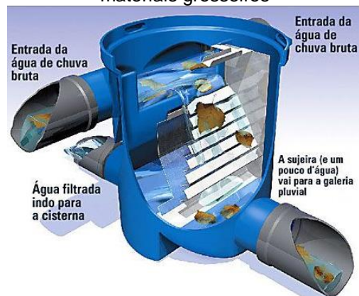
Figura 8 - Modelo de filtro para retenção de materiais grosseiros
