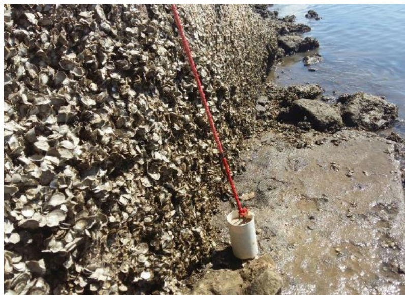
Figura 18: Medidor de marés, de baixo custo desenvolvido por Rezende (2017).
