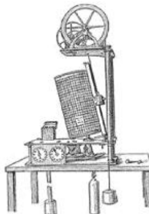
Figura 6: Desenho representativo de marégrafo criado por Lord Kelvin em 1872.
