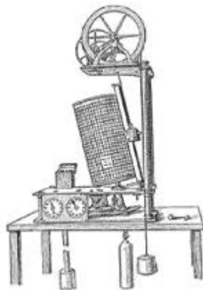
Figura 4: Desenho representativo de marégrafo criado por Lord Kelvin em 1872.
