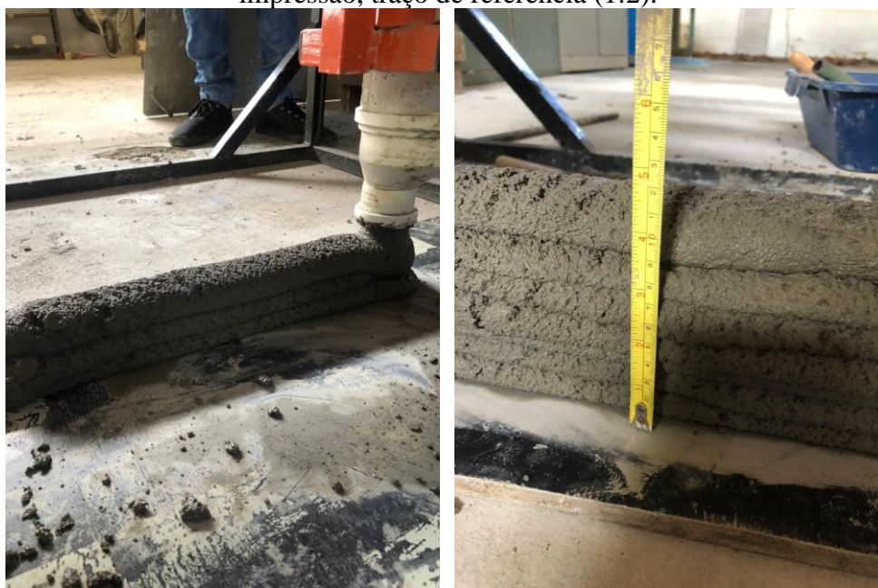
Figura 9 - a) e b) Definição da relação água/materiais secos ideal para as condições de impressão, traço de referência (1:2).
