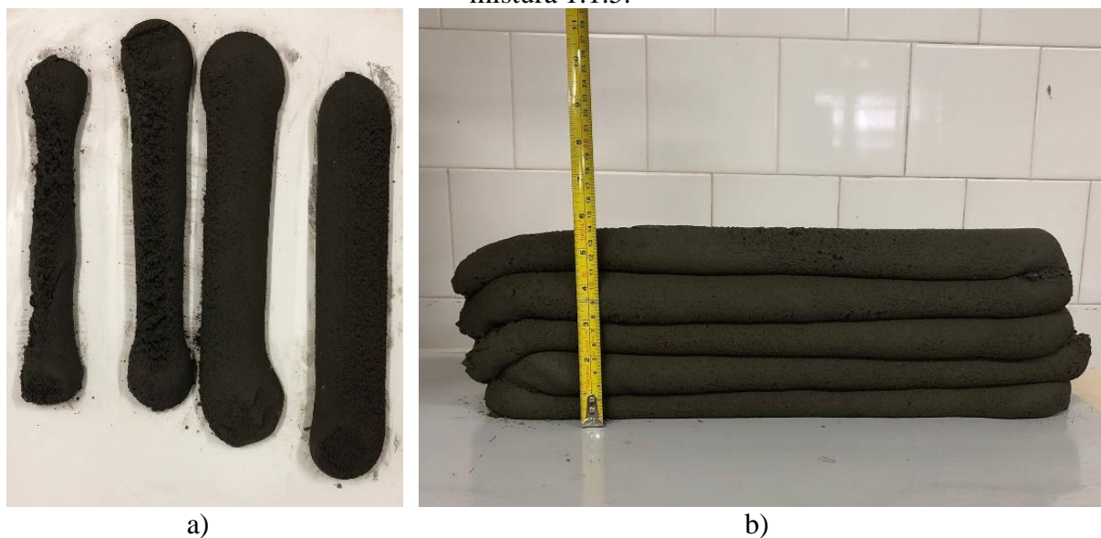
Figura 13 - (a) Determinação da velocidade e taxa de impressão (b) Camadas impressas, mistura 1:1.5.
