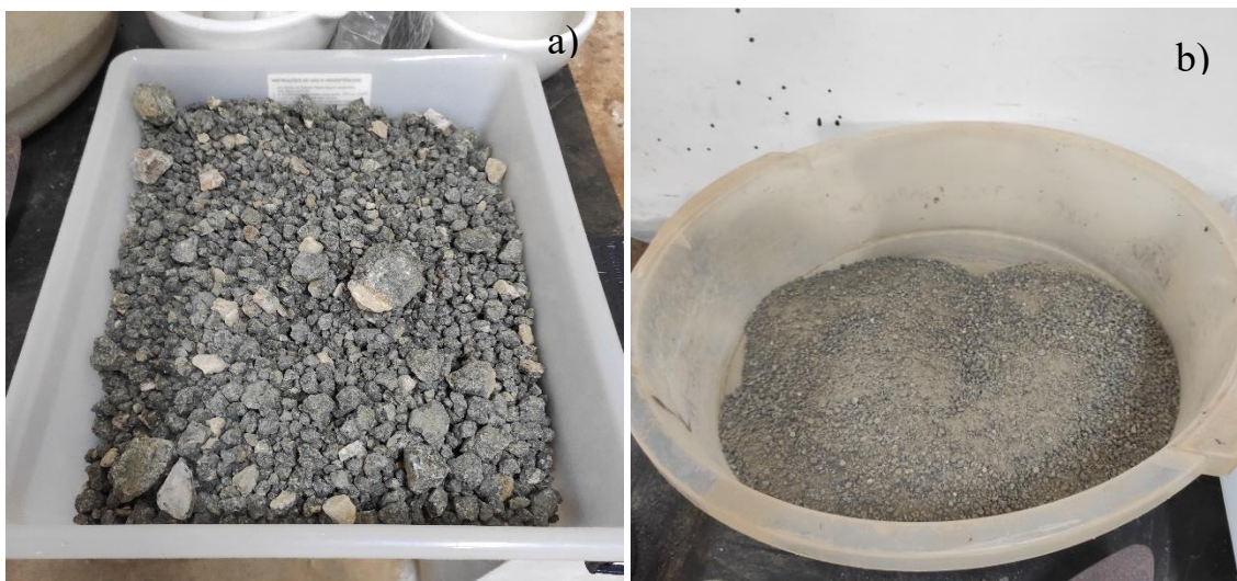
Figura 3.3 – Preparação das amostras de solo para a caracterização geotécnica.
