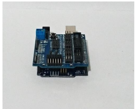
Fig. 35: Conexão Arduino+Shild, passo 6.
