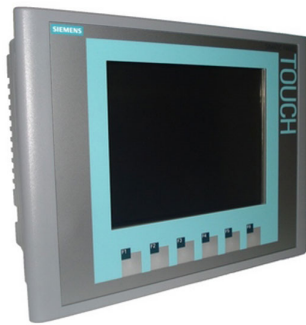
Figura 2.10: Exemplo de Interface Homem-Máquina (IHM). Fonte: Próprio Autor (2016).
