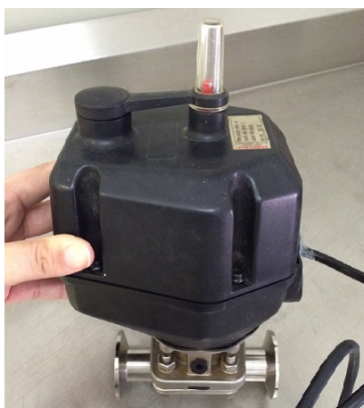
Figura 4.2: Válvula elétrica ON/OFF para utilização no reciclo do loop .
