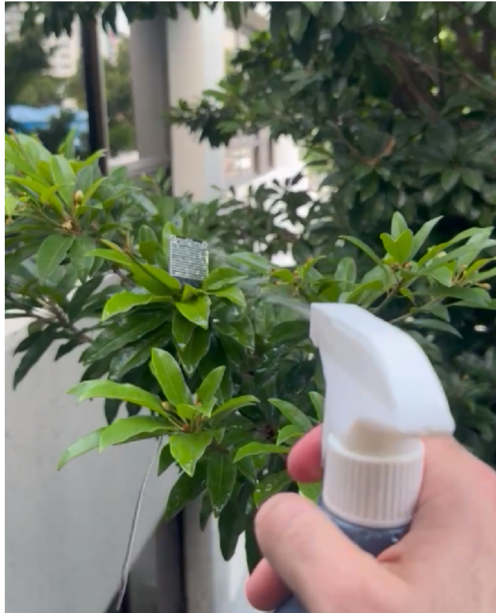
Figura 35 – Teste outdoor do sensor de chuva
