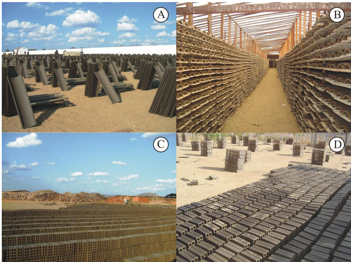
Figura 7: Secagem de produtos cerâmicos. Secagem de telhas no pátio (A) e em prateleiras (B). Secagem de tijolos no pátio da cerâmica (C) e (D). Fonte: Melo; Rodrigo, 2010.
