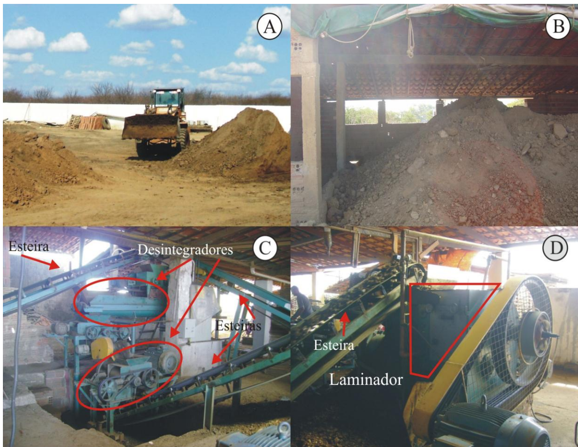
Figura 5: Transporte e armazenamento de argila no caixão alimentador, Desintegrador e Laminador. (A) Transporte da argila por meio de tratores. (B) Caixão alimentador com argila. (C) Desintegrador utilizado para deixar a argila em pedaços menores. (D) Laminador sendo abastecido com a argila fragmentada. Fonte: Melo; Rodrigo, 2010.
