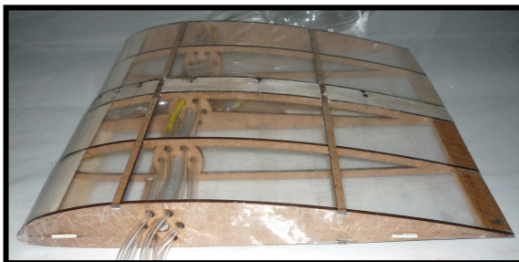
Figura 28. Aerofólio com perfil Clark Y.
