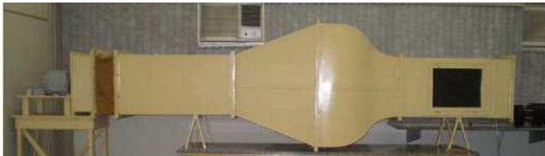
Figura 35 . Túnel aerodinâmico utilizado para os ensaios, (Ford, 2008).
