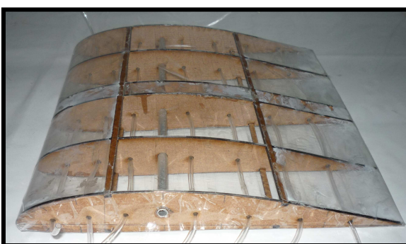
Figura 29. Aerofólio com perfil GA 30-U 613.5.
