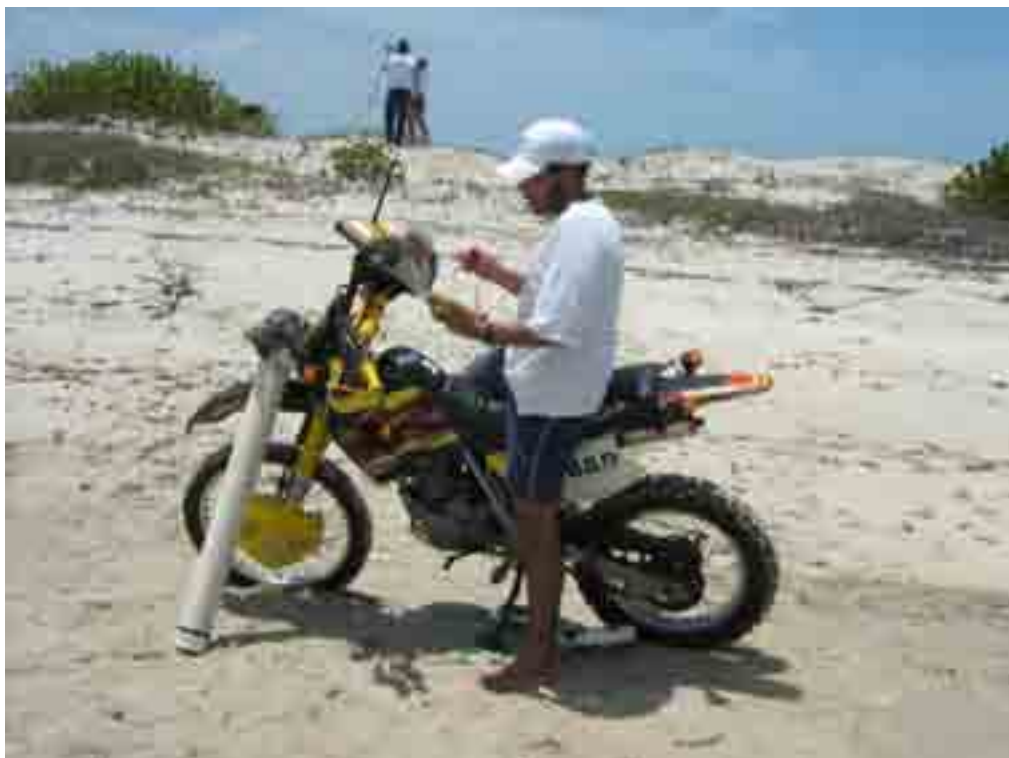
Figura 4.8 – Antena base ao fundo sendo ligada e a antena rover instalada na moto, sendo configurada para o levantamento RTK.
