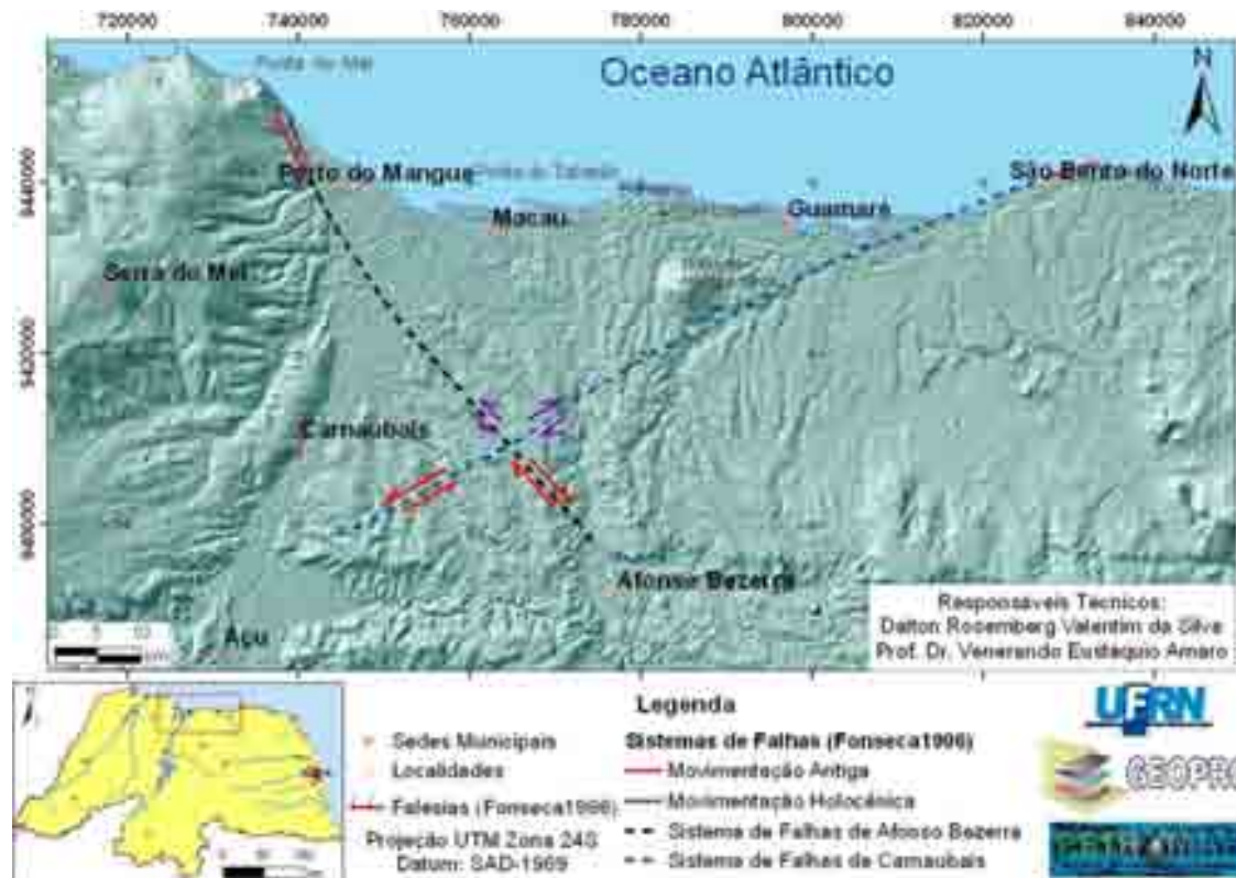
Figura 5.1 – Mapa da representação dos dois principais sistemas de falhas estruturais: Afonso Bezerra e Carnaubais (Fonte: Valentim da Silva, 2008).
