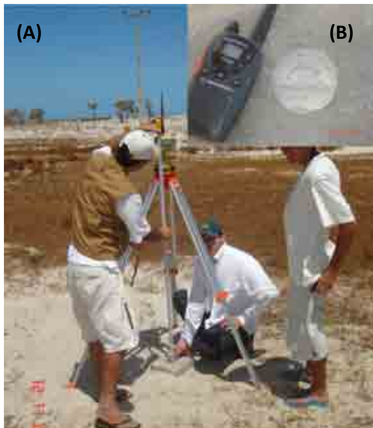
Figura 4.5 – (A) Instalação da antena base a partir do marco de 80 kg. (B) Destaque da chapinha metálica com a identificação do marco instalado.
