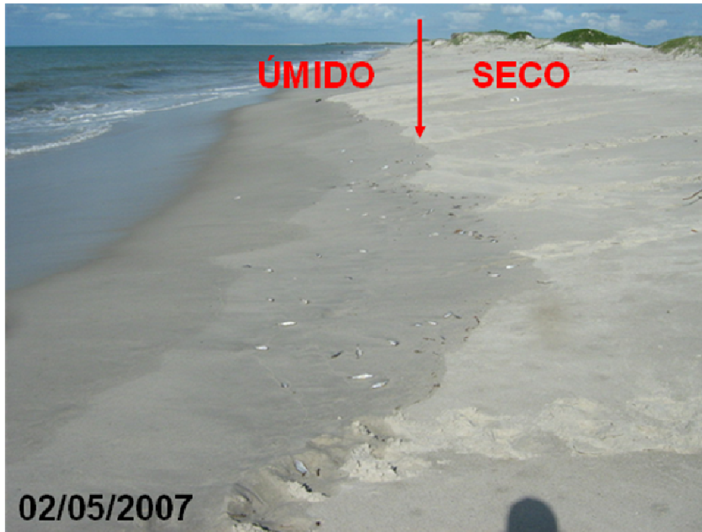
Figura 4.9 – Limite da área úmida e seca utilizada para balizar o levantamento usando o GPS Geodésico.
