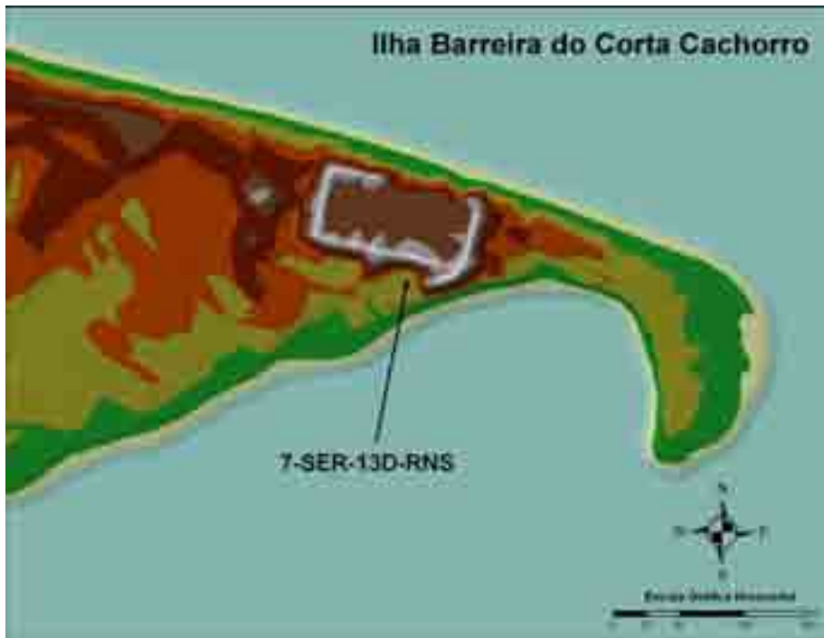
Figura 4.11 – MDT pelo método TIN com a ilustração da plataforma terrestre abandonada devido ao efeito erosivo que atingiu esta área no início do ano de 2006 e isolou a base do campo petrolífero para acesso por estrada.
