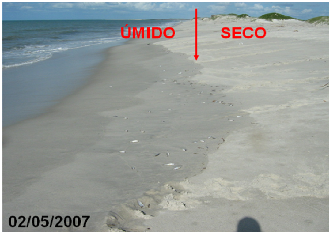
Figura 3.2 – Fotografia em campo mostrando o limite (seco/úmido) utilizado como referência no levantamento da linha de costa extraída nas imagens orbitais.
