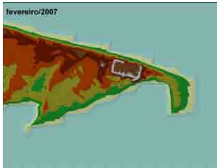
Figura 1.24 – Modelo TIN gerado, sendo utilizado para identificar as áreas com carência de informação altimétrica.
