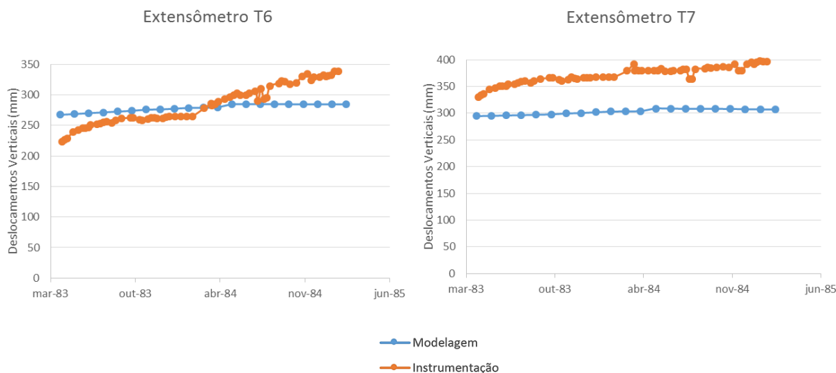
Figura 4.75 – Modelagem versus instrumentação extensômetros T6 e T7
