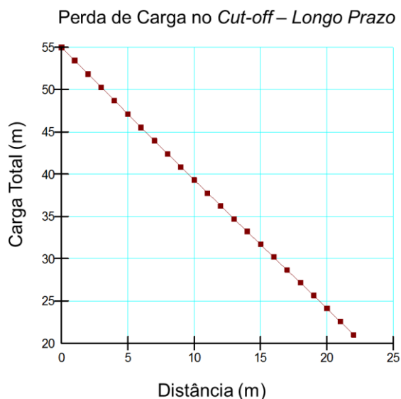
Figura 5.43 – Perda de carga ao longo da espessura do cut-off , longo prazo
