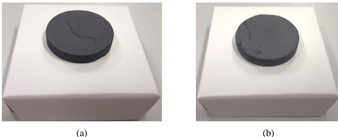
Figura 45: Pastilha de ferrita após processo de sinterização: (a) face apenas com desnível e (b) face com pequenas fissuras.
