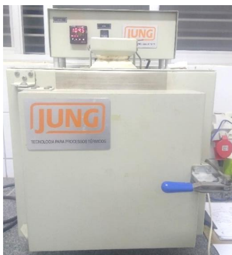
Figura 22: Forno mufla utilizado na calcinação.
