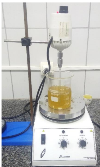
Figura 20: Processo de agitação mecânica da quitosana.
