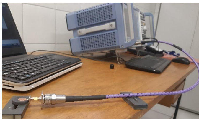
Figura 64: (a) Antenas de geometria circular sobre substrato de ferrita e (b) seu setup de medição.
