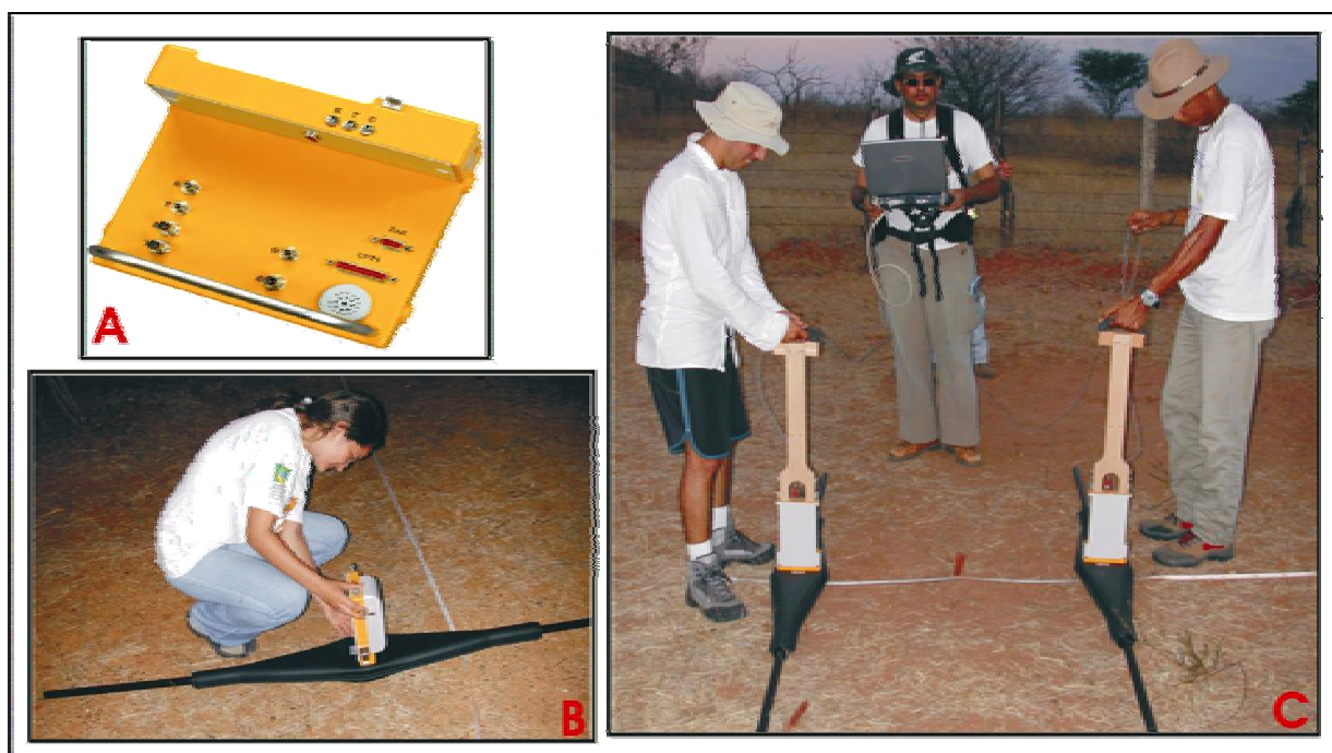
Figura 3.12 Equipamento RAMAC-MALA. A- Unidade de Controle UC-II, B- Antena e Receptor, C- Aquisição dos dados no campo.
