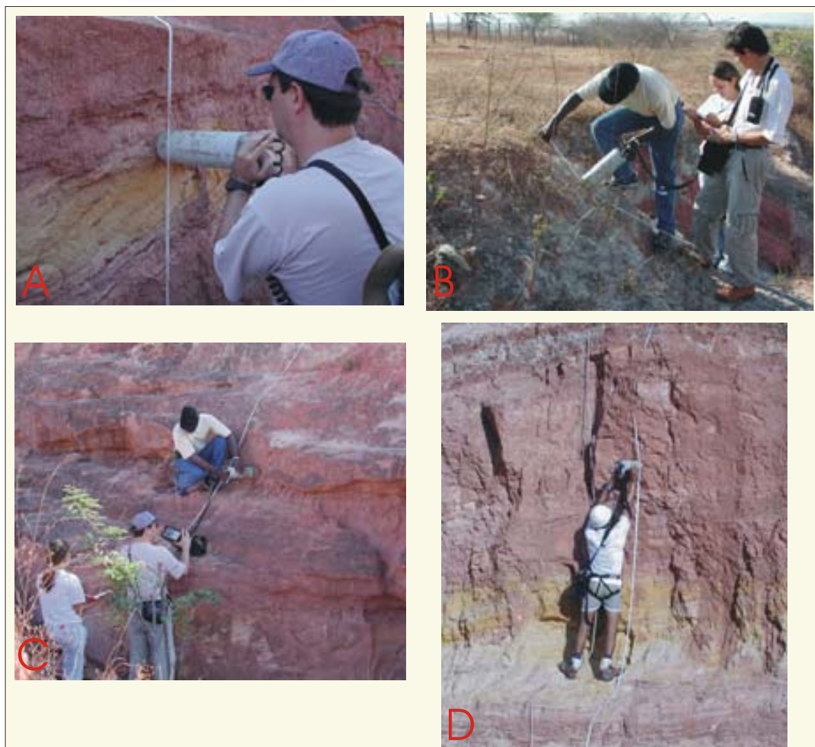
Figura 3.9 Levantamento de perfis com espectrômetro de raios gama. A- Detalhe do emprego do equipamento. B-C Fotos de dois perfis levantados em Apodi. D- Foto do perfil levantado em Olho d'Água da Bica.
