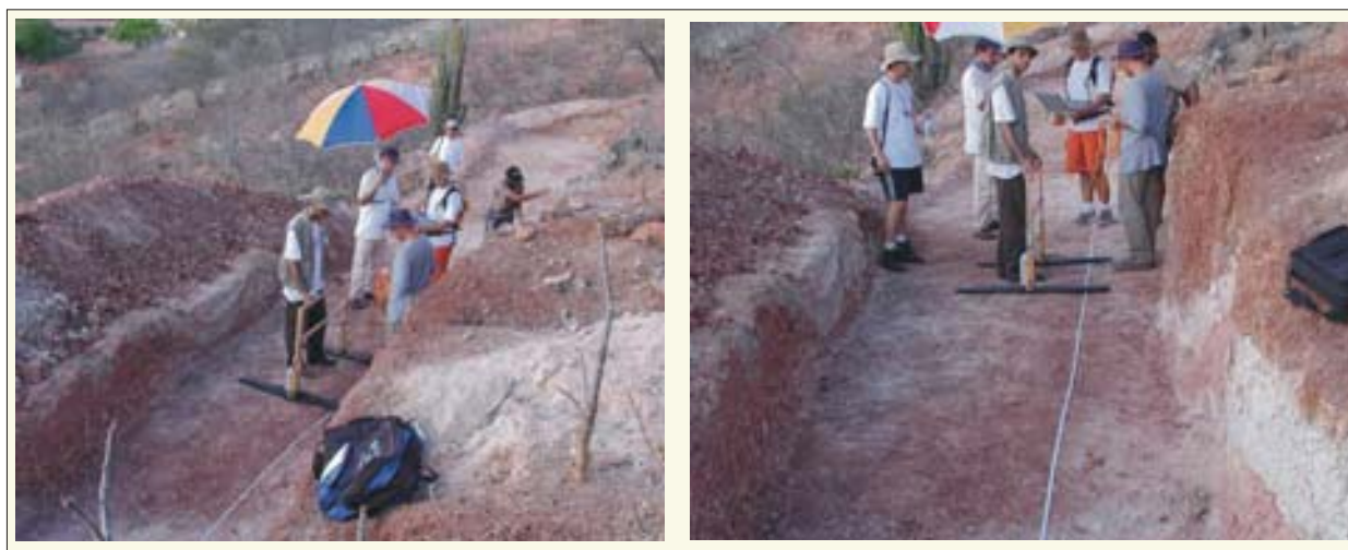
Figura 4.11 Detalhe dos perfis geofísicas com GPR, ressaltando-se a trincheira com paredes laterais, aberta a aproximadamente 8m acima da base do afloramento.
