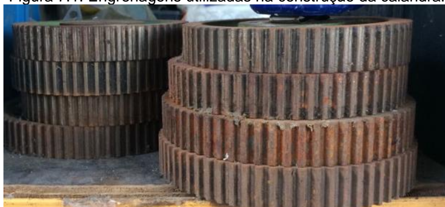
Figura 7.1: Engrenagens utilizadas na construção da calandra.
