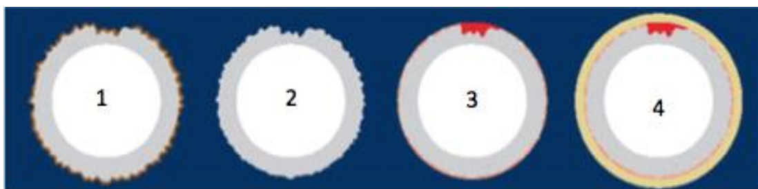
Figura 2.39 – Etapas de execução de reparo. (1) duto danificado com resíduos, (2) remoção de resíduos do duto, (3) aplicação da camada de primer e (4) aplicação material compósito Fonte: Rust, 2018.
