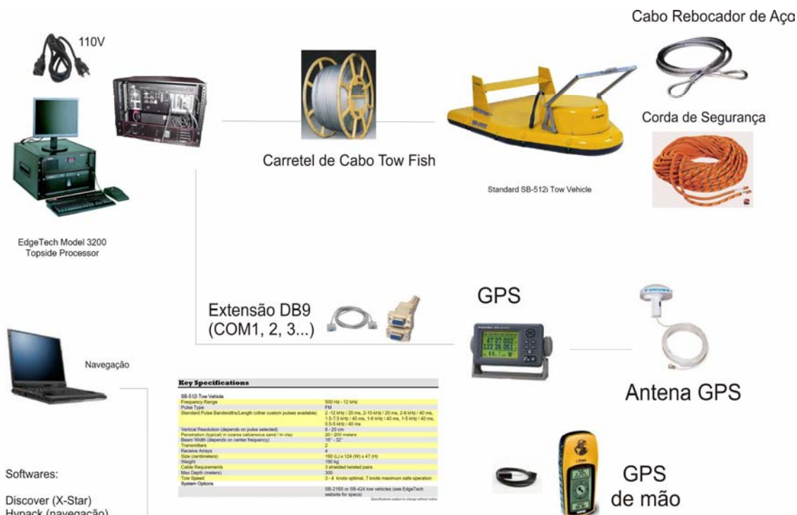
Figura 4.21 – Esquema de montagem dos equipamentos de aquisição de sísmica rasa para o sistema 3200-XS.
