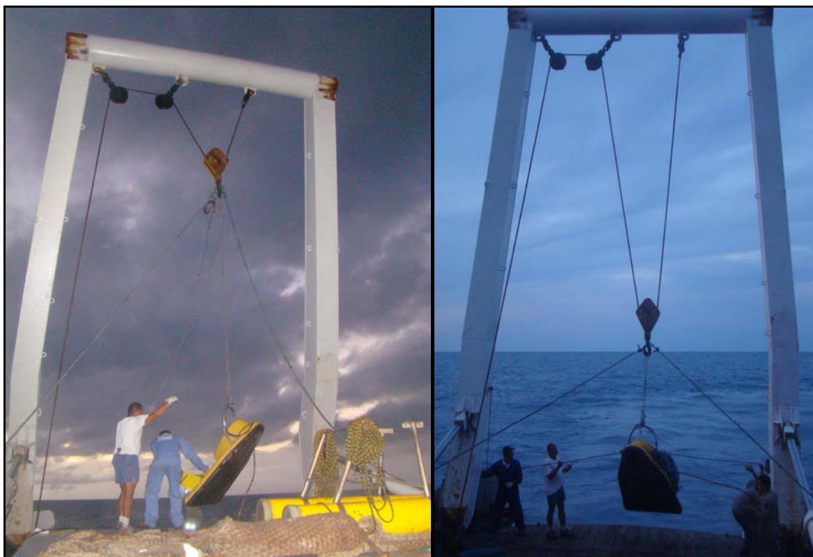
Figura 4.26 - Pórtico de popa utilizado para içar o X-Star .
