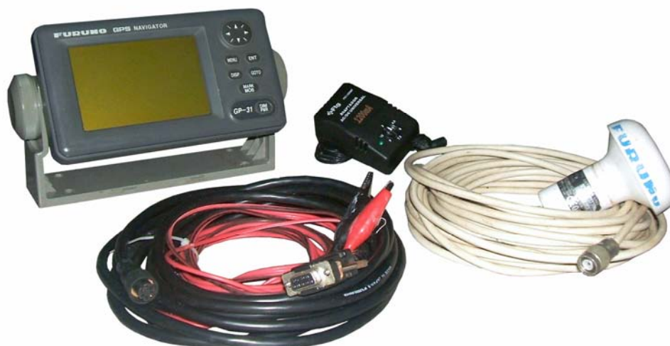
Figura 4.12 – GPS GP-31 da marca Furuno com antena externa, cabo de dados e de alimentação e adaptador AC/DC.
