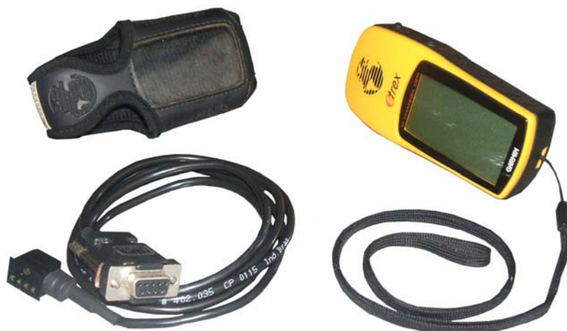
Figura 4.11 – GPS portátil eTrex da Garmin com capa e cabo serial de comunicação de dados.
