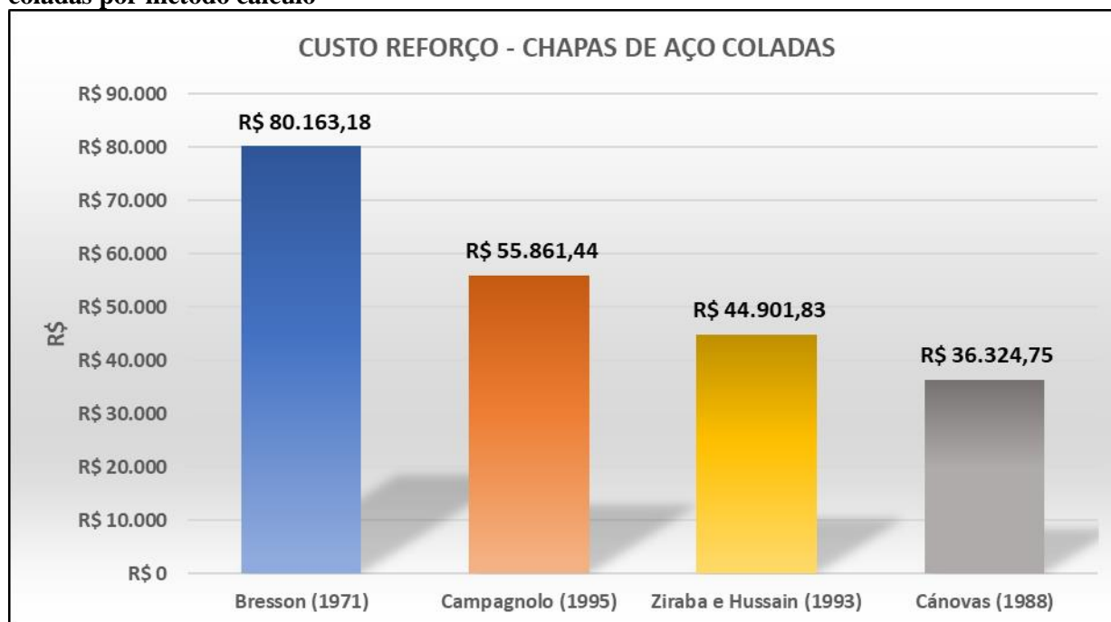
Figura 65 - Gráfico dos custos para execução do reforço na longarina utilizando chapas de aço coladas por método cálculo
