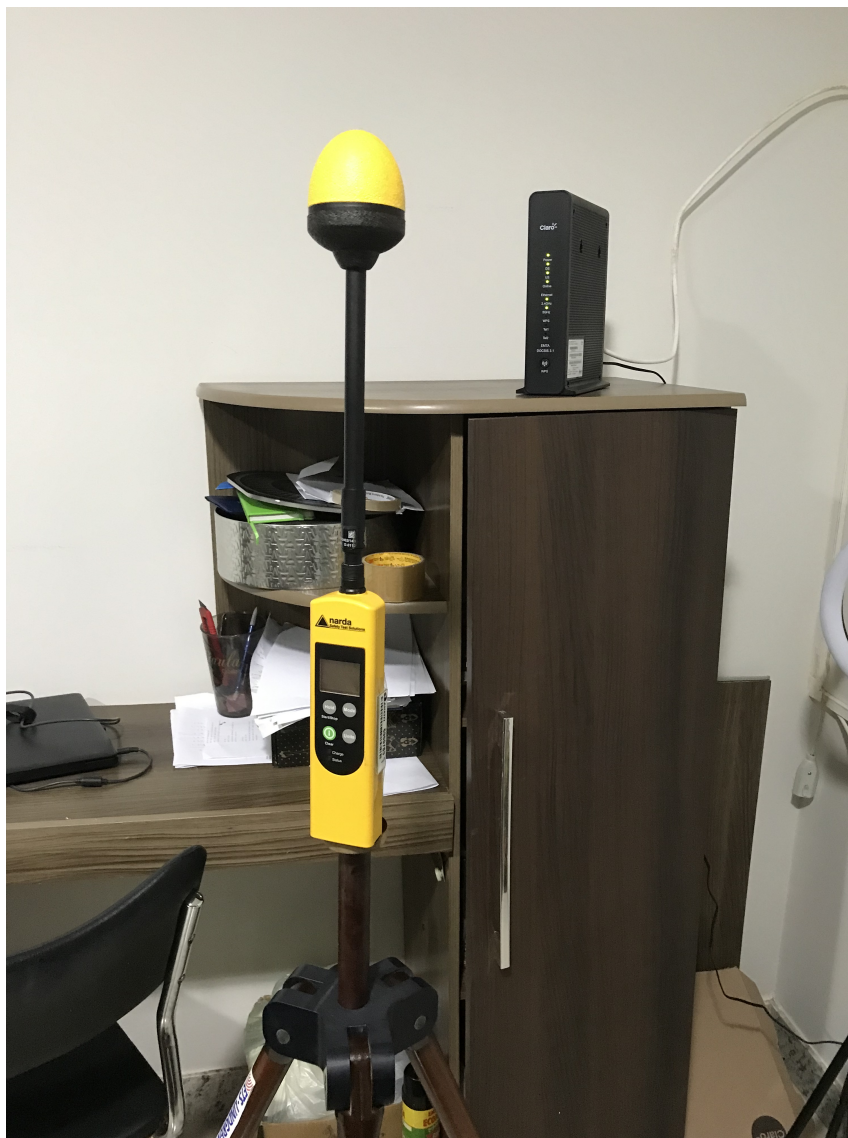
Figura 4.6: Foto do setup de medição para ponto de acesso Wi-Fi.
