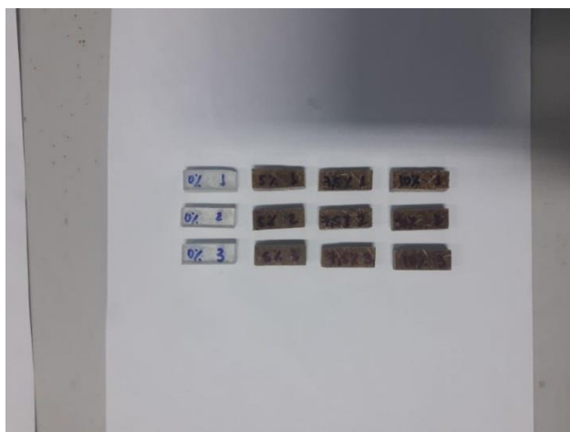
Figura 18 - Corpos de provas para ensaio de absorção de água.
