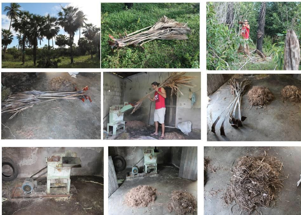
Figura 8 - Etapas do processamento das fibras de carnaúba.
