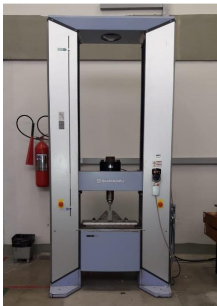
Figura 15 - Máquina Universal Shimadzu, modelo AGX 300 e que tem capacidade máxima.
