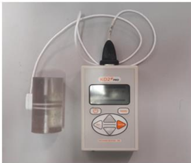
Figura 17 - Corpo de prova da resina poliéster em ensaio de análise térmica.
