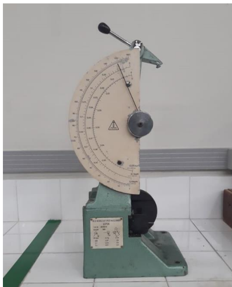
Figura 14 - Máquina utilizada para ensaio de impacto Charpy.
