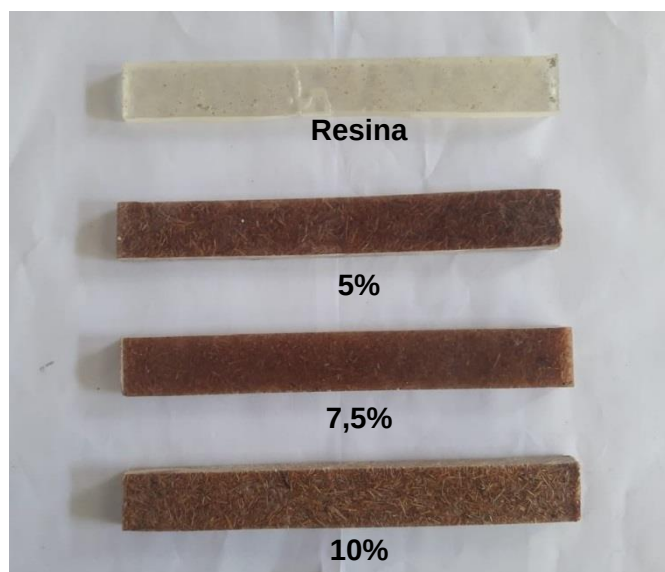
Figura 16 - Corpos de prova de cada formulação para ensaios de tração e flexão em três pontos.
