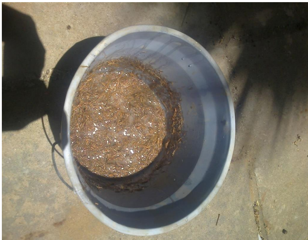
Figura 11 - Mistura entre os componentes do compósito, resina poliéster e PPFC.
