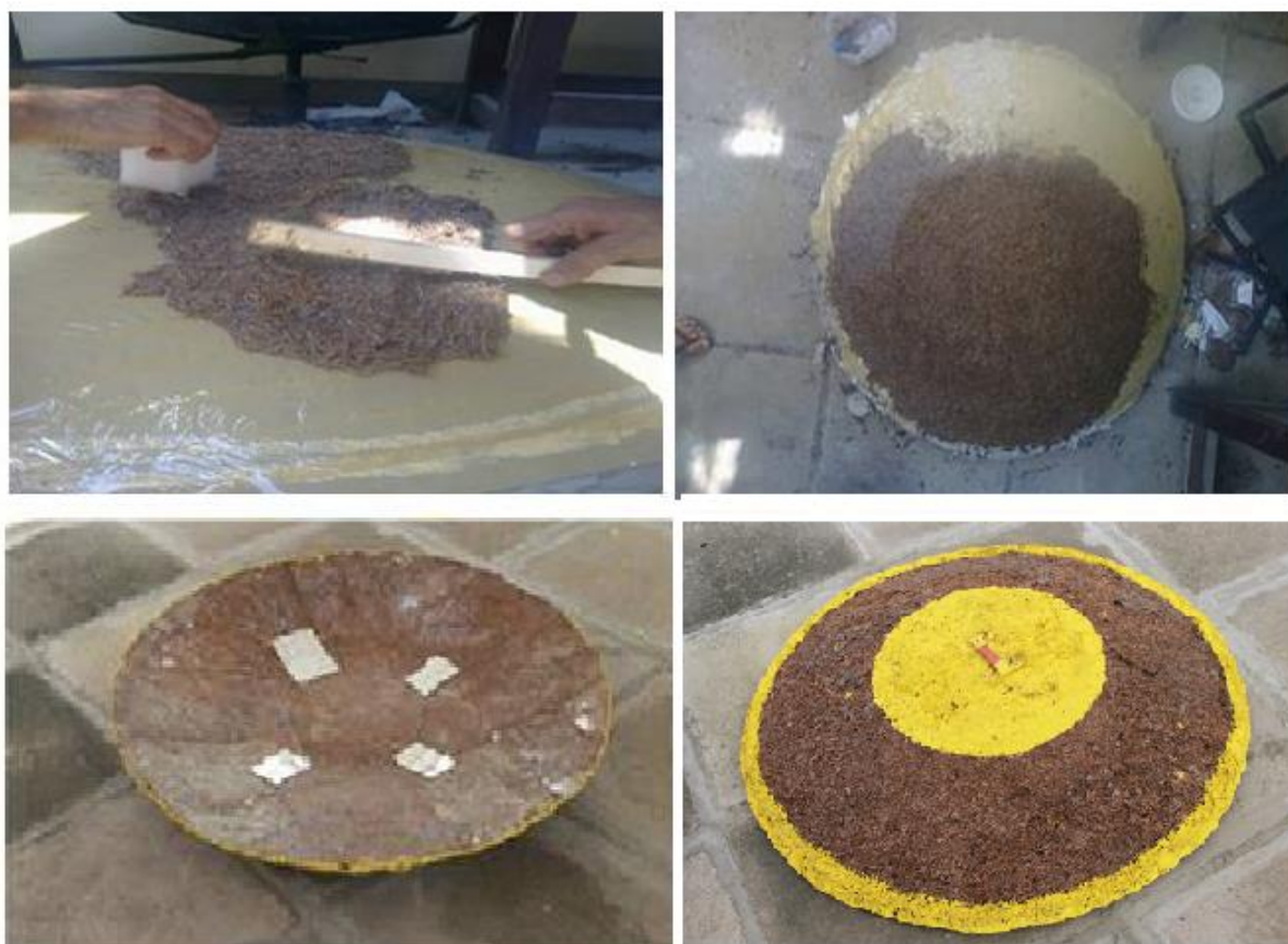
Figura 23 - Etapas do processo de fabricação da parábola do fogão solar à concentração (aplicabilidade do compósito estudado).
