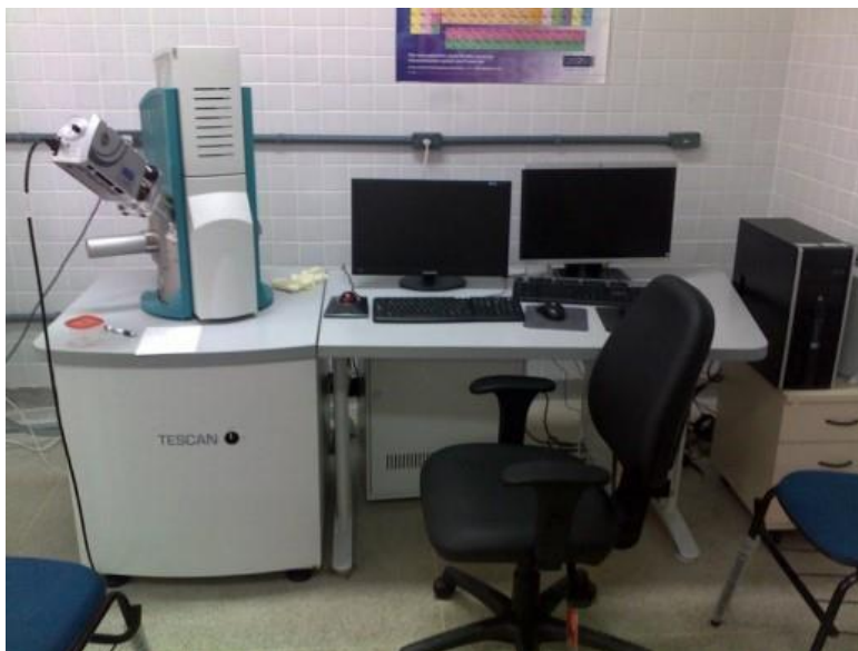
Figura 22 - Equipamentos para análise de microestrutura - MEV.
