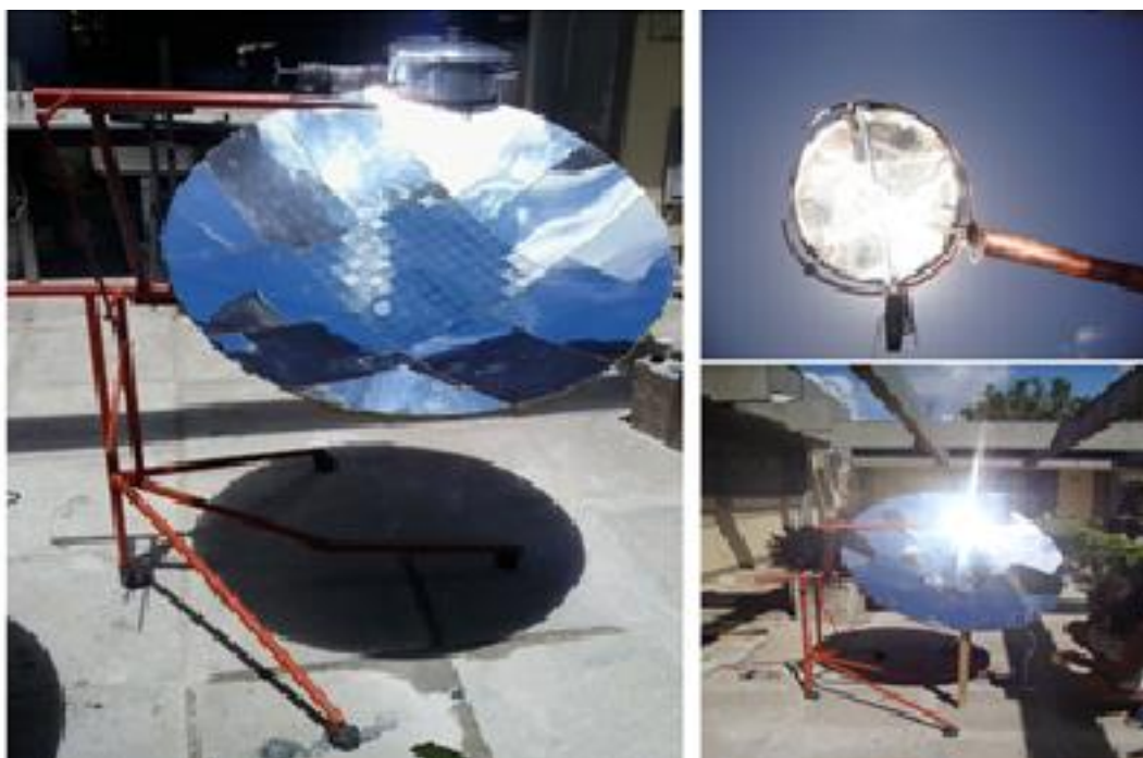
Figura 24 - Fogão solar à concentração com parábola absorvedora fabricada em compósito de resina de poliéster e PPFC.
