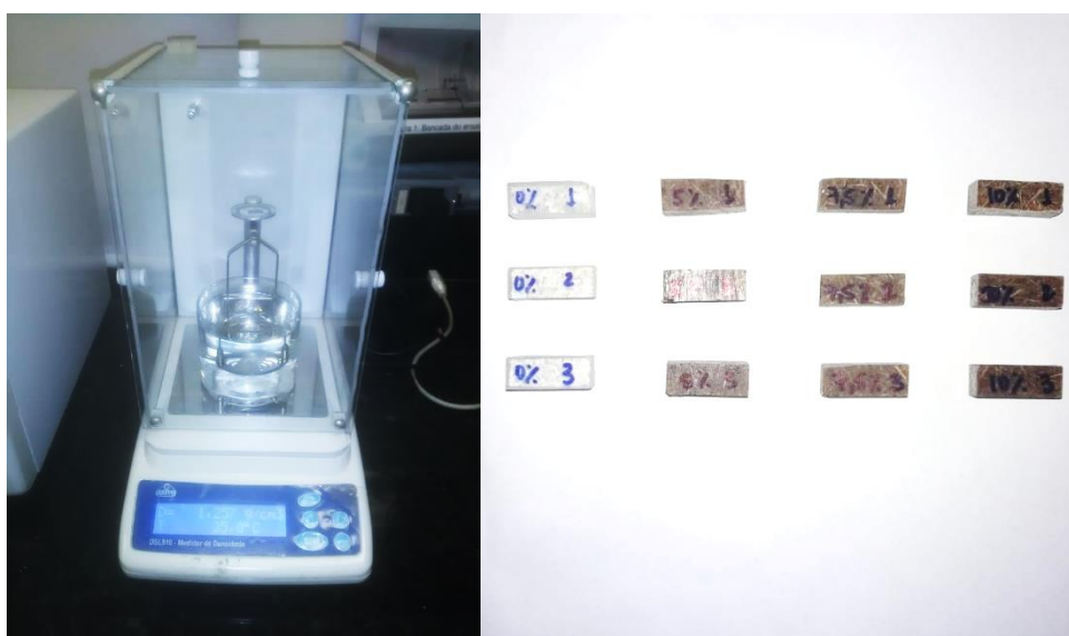
Figura 19 - a) Densímetro digital DSL 910 utilizados no ensaio de densidade aparente e b) Uma amostra de cada formulação do compósito.
