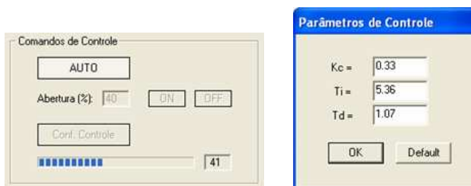
Figura 3.8. Janela de configuração dos parâmetros da lei de controle PID (à direita) acessada através do botão “Conf. Controle” na janela principal (à esquerda).
