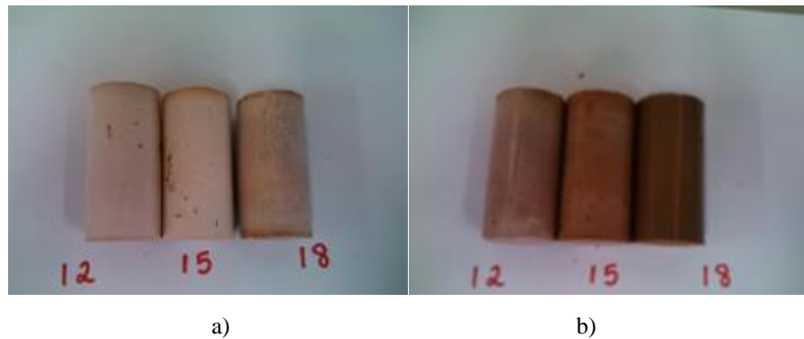
Figura 14 – Análise visual dos corpos de prova curados aos 28 dias, em a) estufa; b) temperatura ambiente
