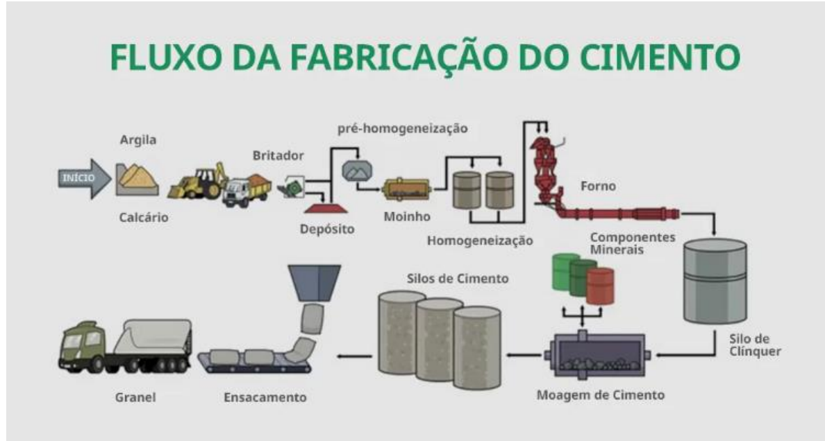
Figura 06 – Processo de produção do cimento Portland
