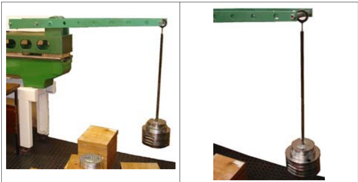
Figura 34: Calibração do padrão de torque.
