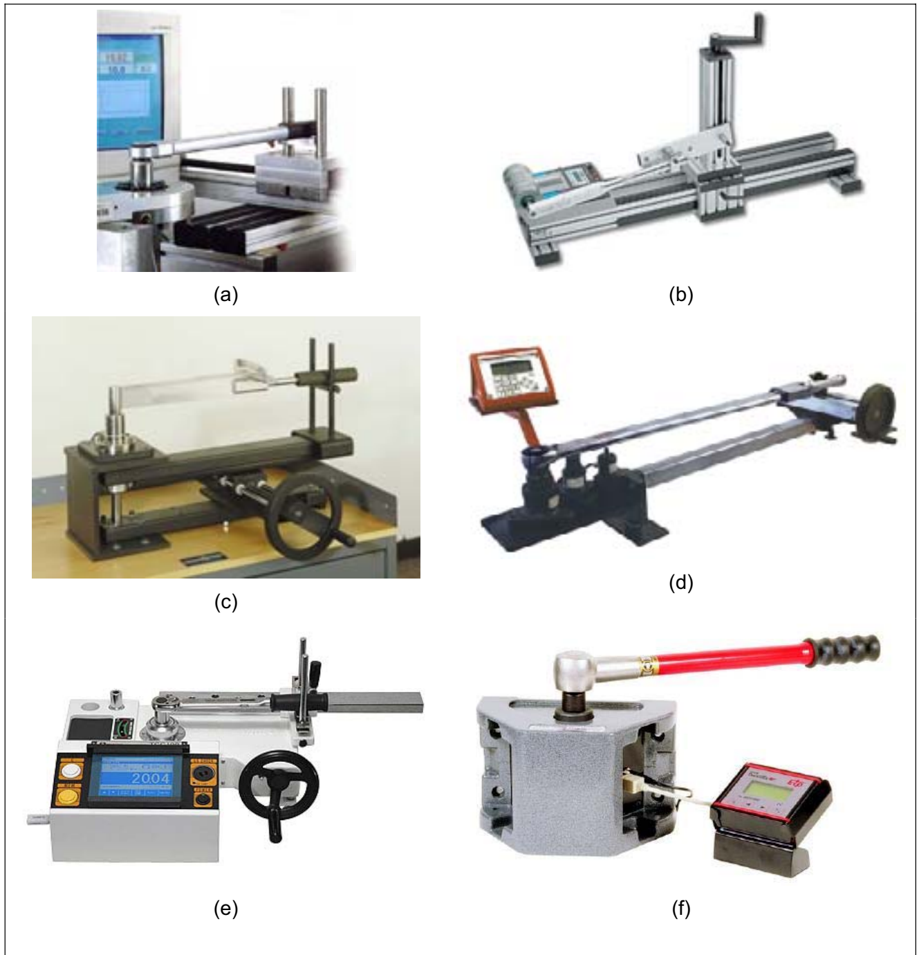
Figura 15: Calibração de torquímetros por meio de transdutores (INTERTURBINE, 2005; PRORE, 2005; STURTEVANT, 2005; NORBAR, 2005; TOHNICH, 2005; MOUNTZ, 2005).
