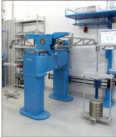
Figura 12: Padrão primário de torque (PUSA; SACHS, 2006).
