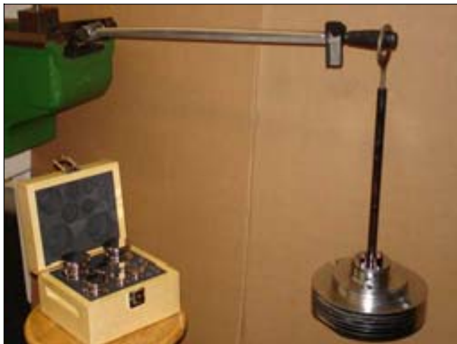
Figura 14: Calibração de torquímetro pelo sistema direto.
