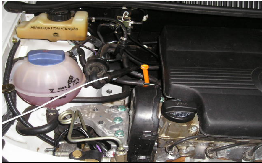
Figura 41: Sonda de temperatura conectada ao tubo da vareta de medição do nível de óleo lubrificante do motor
