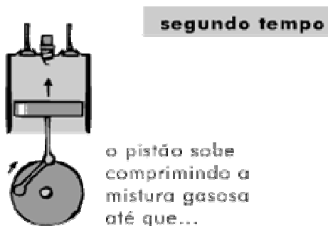
Figura 20: 2º Tempo do motor (compressão)
