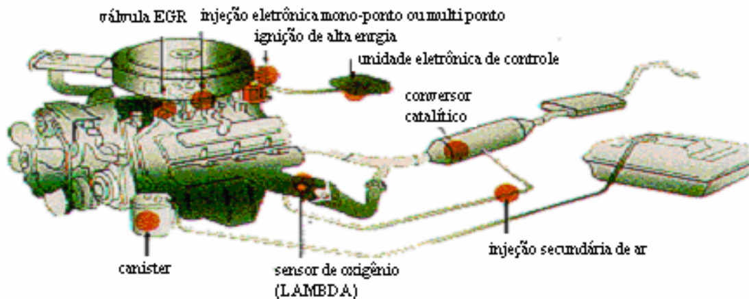
Figura 25: Sistema de controle de emissões veiculares
