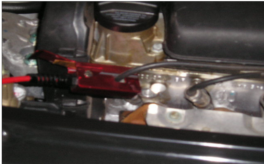
Figura 38: Sensor captador de rotação conectado a um cabo de vela
