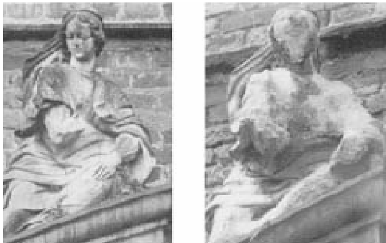
Figura 10: Desgaste ocasionado pela chuva ácida num período de 60 anos – estátua de mármore localizada no Castelo de Herten – Alemanha
