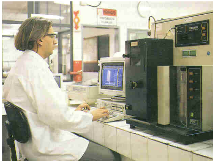
Figura 13: Técnico acompanha uma destilação de gasolina em aparelho automático no laboratório da REGAP.
