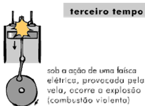
Figura 21: 3º Tempo do motor (ignição)
