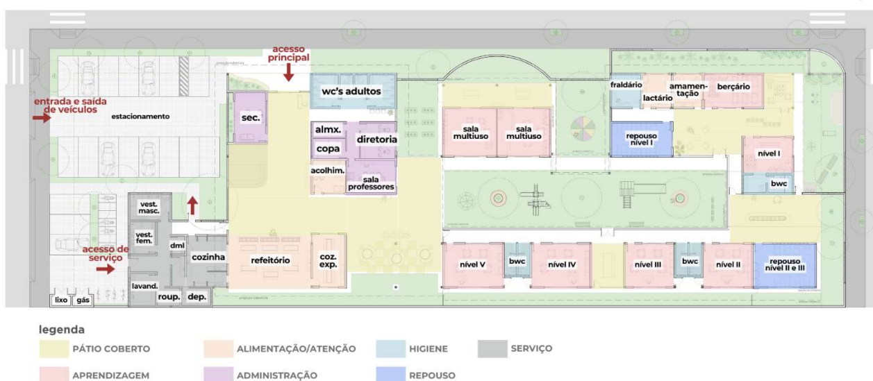
Figura 54: Setorização em planta
