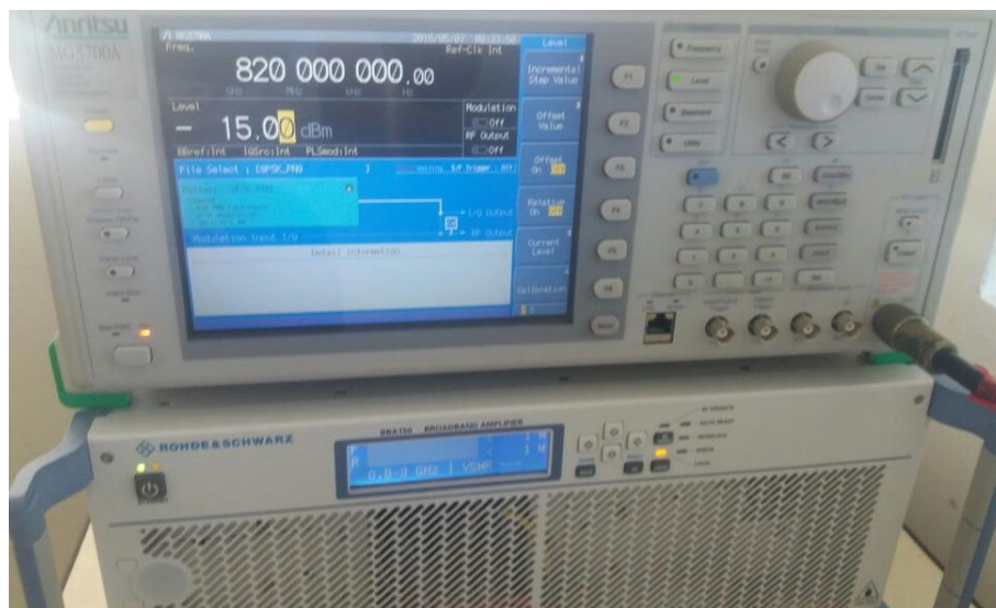
Figura 3: Transmissor de ondas de rádio e amplificador de banda larga. Fonte: o autor.
