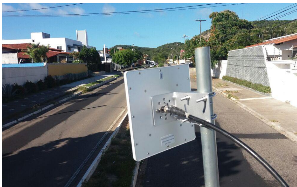
Figura 2: Uma das ruas do bairro de Lagoa Nova, com destaque para a antena em painel, utilizada para receber o sinal. Fonte: o autor.
