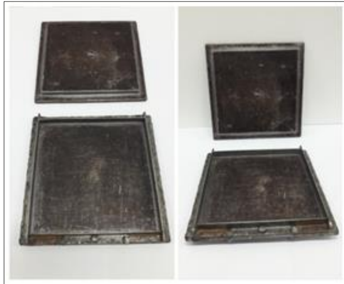
Figura 6 - Molde metálico 01 utilizado na fabricação dos corpos de prova dos ensaios de resistência à tração e à flexão.
