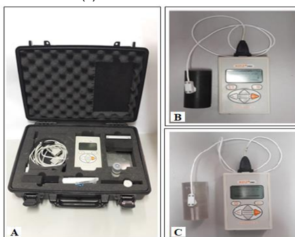
Figura 19 - Analisador KD2 PRO (a) utilizado para o levantamento das propriedades térmicas, dos corpos de prova do compósito (b) e da resina (c) no ensaio de análise térmica.
