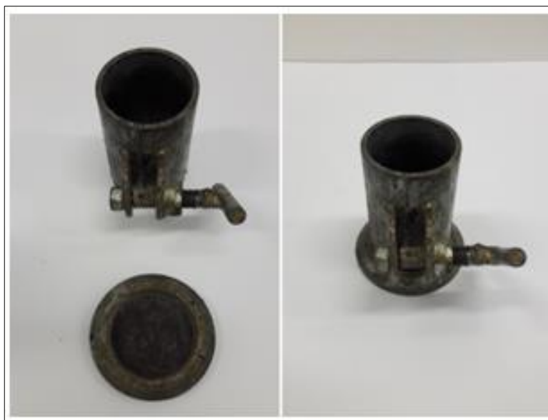
Figura 8 - Molde metálico 03 utilizado na fabricação dos corpos de prova do ensaio de propriedades térmicas.
