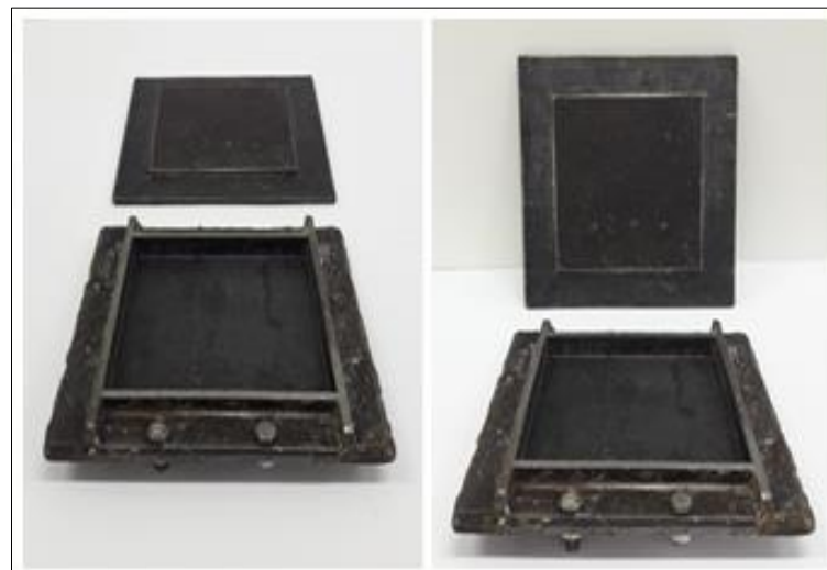
Figura 7 - Molde metálico 02 utilizado na fabricação dos corpos de prova dos ensaios de resistência ao impacto.
