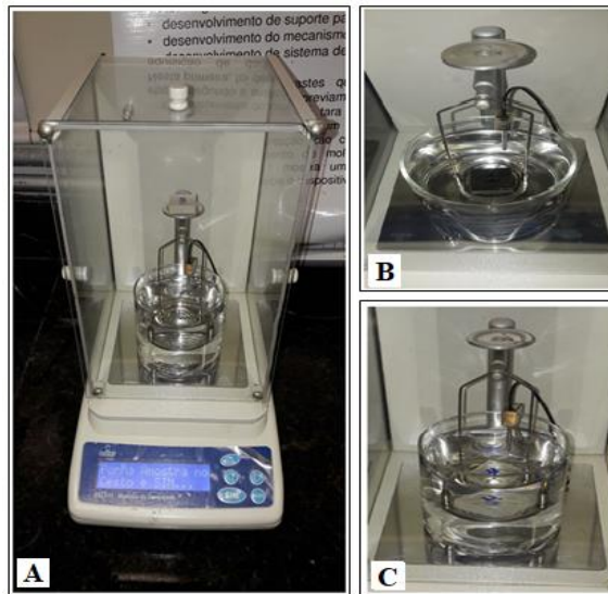
Figura 17 – O densímetro digital DSL 910 (a), os corpos de prova do compósito (b) e da resina (c) no ensaio de densidade.
