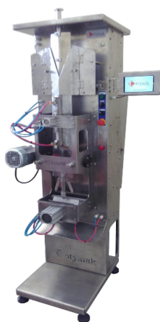
(b) Máquina de envase de fabricação própria com o primeiro protótipo instalado
