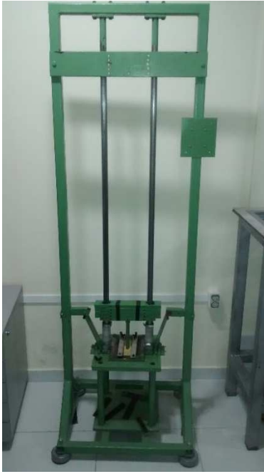
Figura 3.10: Máquina de impacto por queda de peso para materiais compósitos.
