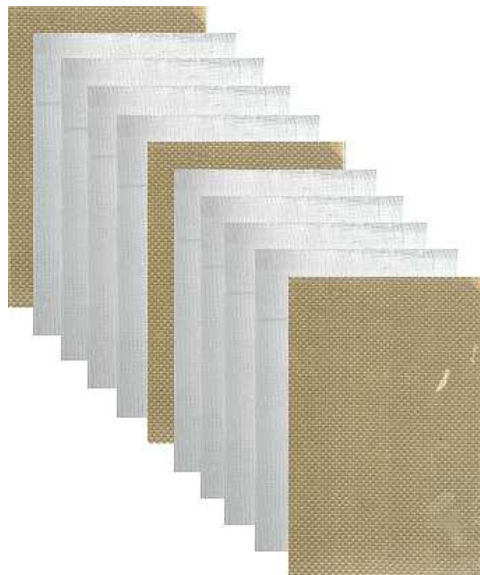
Figura 3.3: Disposição dos tecidos para a laminação do compósito híbrido
