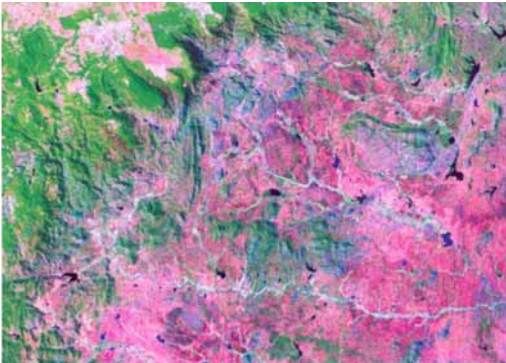
Figura 5.19: Detalhe rede de drenagem (embasamento cristalino) a norte do platô de Santana. Observar o controle do fraturamento E-W em alguns trechos do Rio Bodó.
