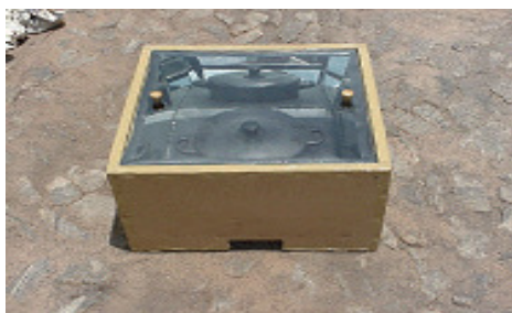
Figura 3.3. Fogão 1 Tipo Estufa.
