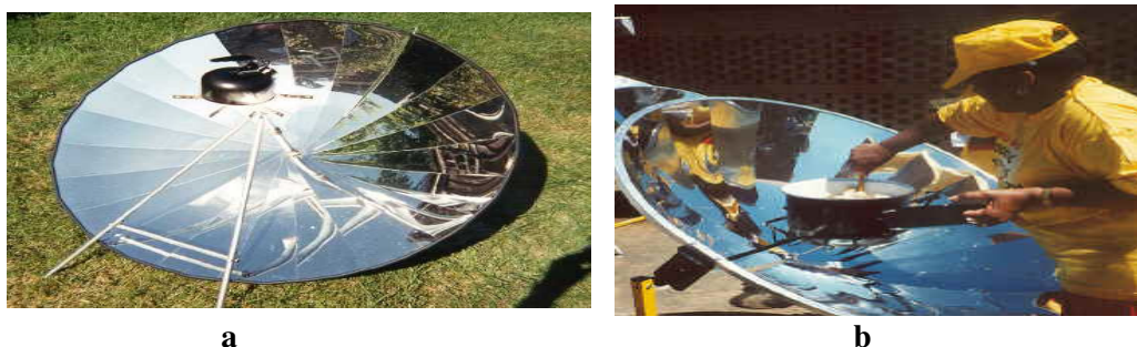
Figura 3.10. (Figuras: a, b). Fogões Concentradores
