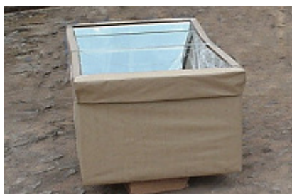
Figura 3.4. Fogão 2 Tipo Estufa.
