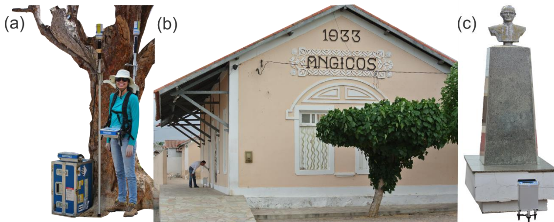
Fig. 5. Alguns equipamentos utilizados nas aquisições. (a) Par de magnetômetros; (b) Ponto de referência gravimétrica na cidade de Angicos-RN; (c) Estátua em Pedro Avelino-RN, onde uma nova base foi estabelecida para abertura e fechamento de cada dia do levantamento gravimétrico.
