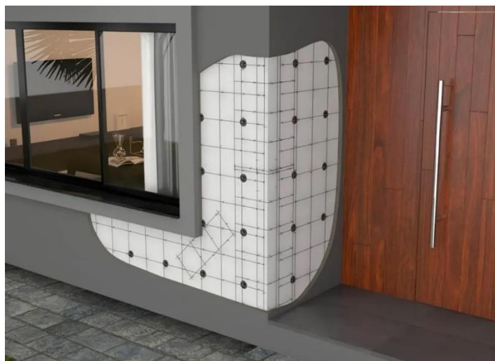
Figura 2.30 - Revestimento de um painel monolítico
