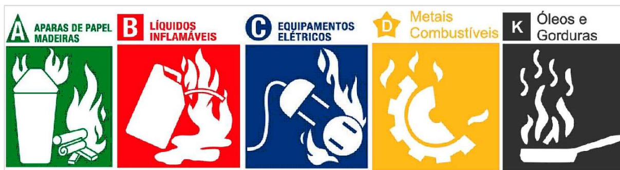
Figura 3.11 - Simbologia das classes de incêndio.
