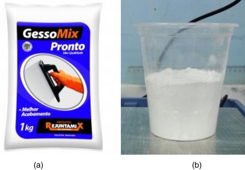
Figura 3.1: O gesso utilizado no trabalho: (a) embalado; (b) pronto para ser adicionado à vermiculita
