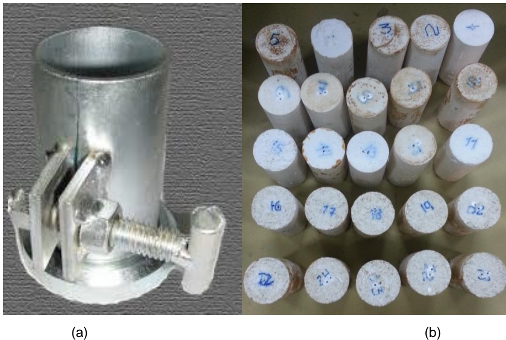
Figura 3.3: (a) molde; (b) corpos de prova cilíndricos prontos para ensaios de propriedades térmicas.
