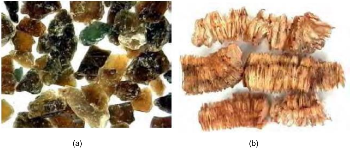
Figura 2.2: Amostras de vermiculita: (a) natural e (b) expandida
