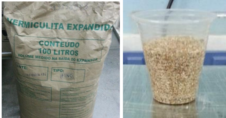
(a) (b) Figura 3.2: A vermiculita expandida utilizada no trabalho: (a) embalada; (b) pronto para ser adicionado ao gesso.
