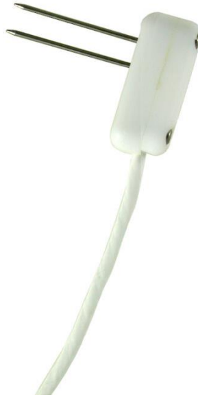
Figura 3.5: Sonda SH-1 do medidor de propriedades térmicas KD2 Pro
