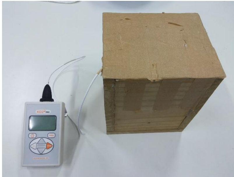
Figura 3.6: Bancada com KD2-Pro e câmara térmica
