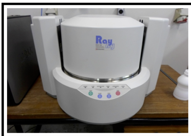
Figura 17 – Espectrômetro para análise química da palha de aço e do compósito obtido.
