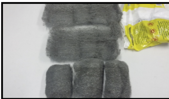
Figura 6 – Fibra de aço(palha de aço) utilizada no compósito estudado.
