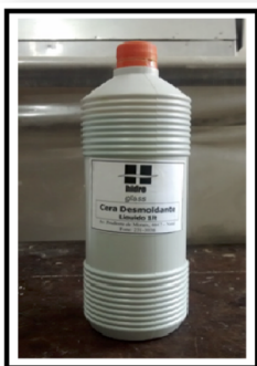
Figura 7 – Desmoldante aplicado nas superfícies do molde.
