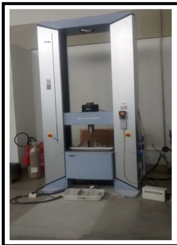
Figura 10 – Máquina universal utilizada nos de ensaios a tração e flexão.
