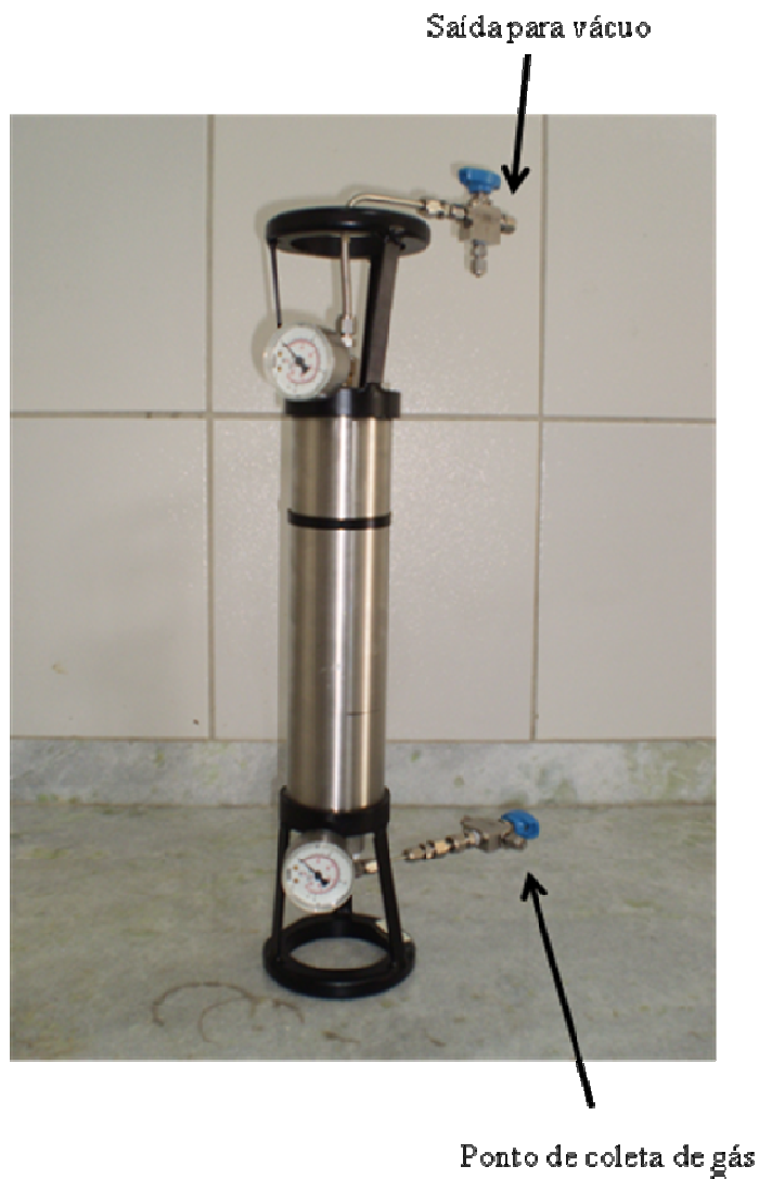
Figura 5.22 – Dispositivo usado na coleta de gás produzido durante a pirólise de lodo de esgoto em reator do tipo cilindro rotativo
