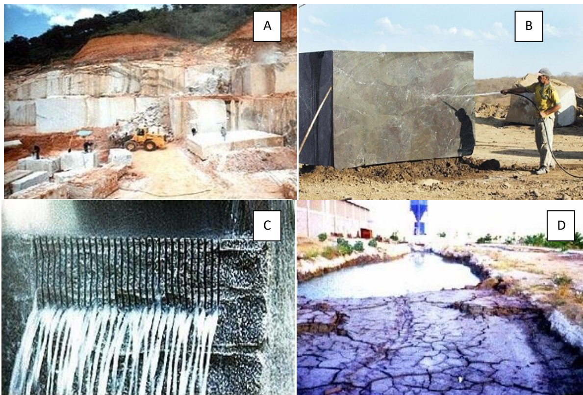
Figura 11. Danos ambientais A) Extração de Rochas Ornamentais. B) Bloco de Rochas Ornamentais. C) Corte com Ajuda de Lama Abrasiva. D) Decomposição do Resíduo do Corte.
