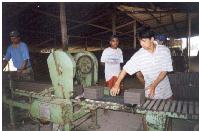
Figura 2.13 – Confecção de blocos cerâmicos (Alves, 2003)
