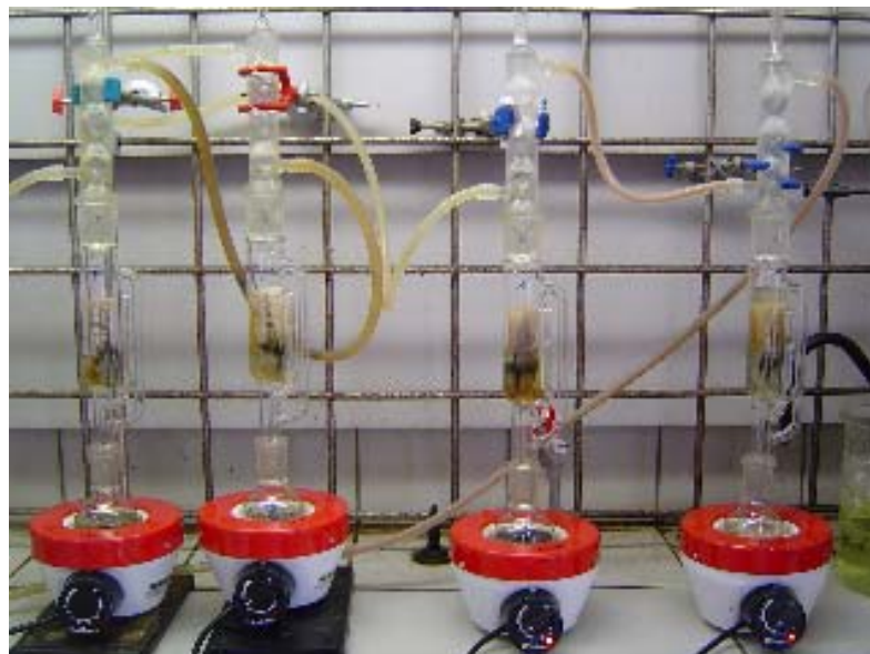
Figura 4.5 – Extração via soxhlet convencional.
