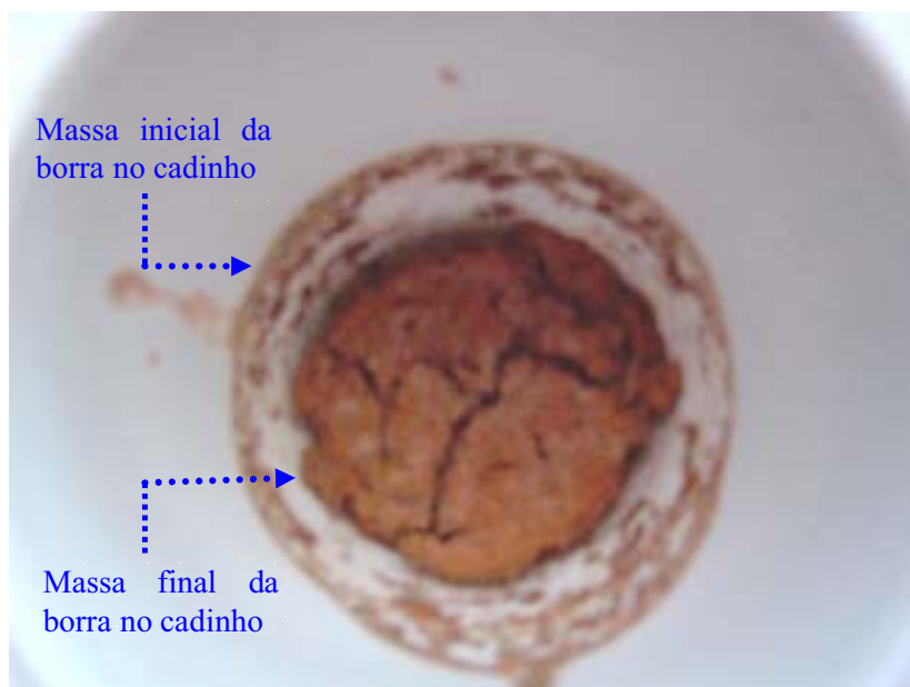
Figura 5.7 – Borra de petróleo após incineração na mufla.
