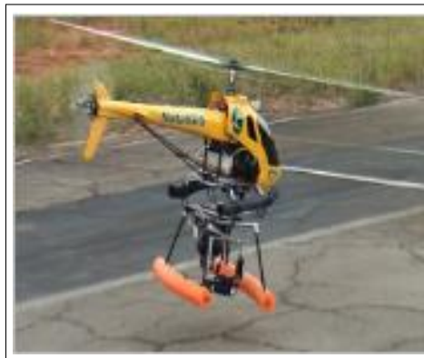
Figura A.2: Aeromodelo JR GSR260 Voyager Gás - destaque na plataforma de acoplamento da câmera
