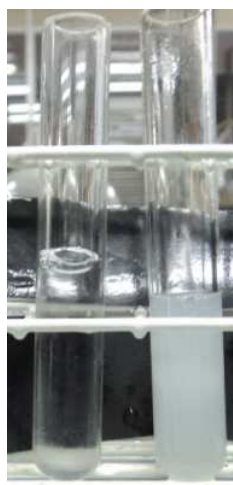
Figura 4.3 Representação visual na formação do ponto de turbidez.
