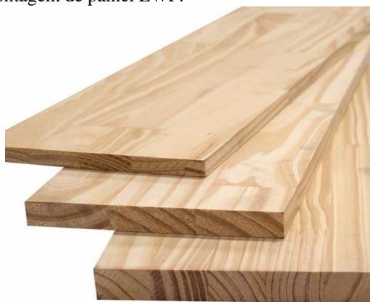
Figura 5 - Madeira pinus a ser utilizada para montagem de painel LWF.
