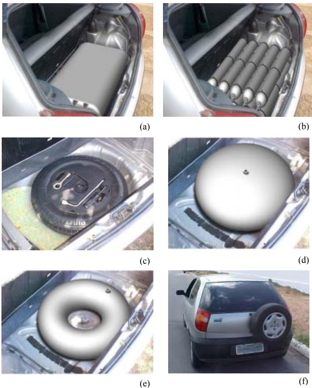
FIGURA 4.3 – Fiat Palio EX (a) Reservatório modular instalado no porta-malas (b) Reservatório de galerias elípticas instalado no porta-malas (c) Cavidade para o pneu reserva (d) Protótipo elíptico posicionado na cavidade do pneu de reserva (e) Protótipo toroidal posicionado na cavidade do pneu de reserva. (f) Reposicionamento do pneu de reserva na porta traseira do veículo.
