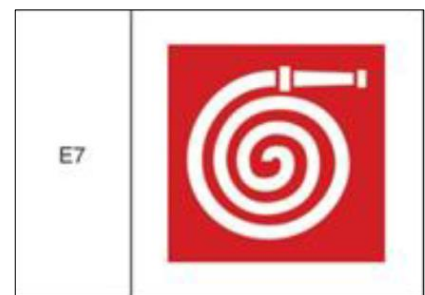
Figura 26 – Sinalização para abrigo de mangueira e hidrante.
