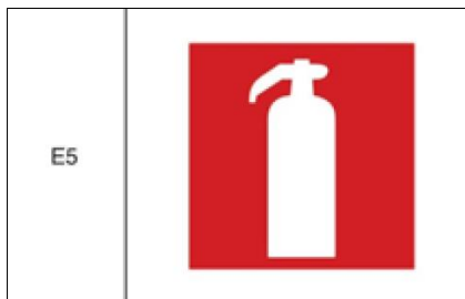
Figura 25 – Sinalização para extintor de incêndio.
