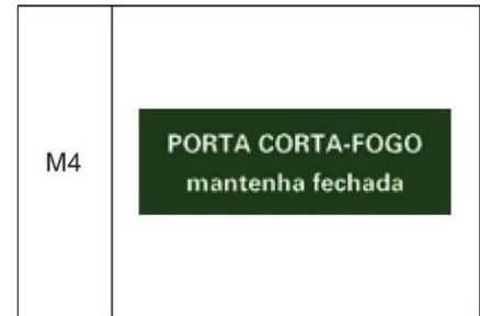
Figura 31 – Sinalização para porta corta-fogo.
