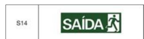
Figura 29 – Sinalização para indicação de saída de emergência.
