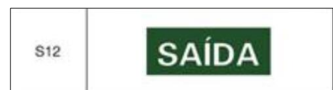
Figura 28 – Sinalização para saída de emergência.
