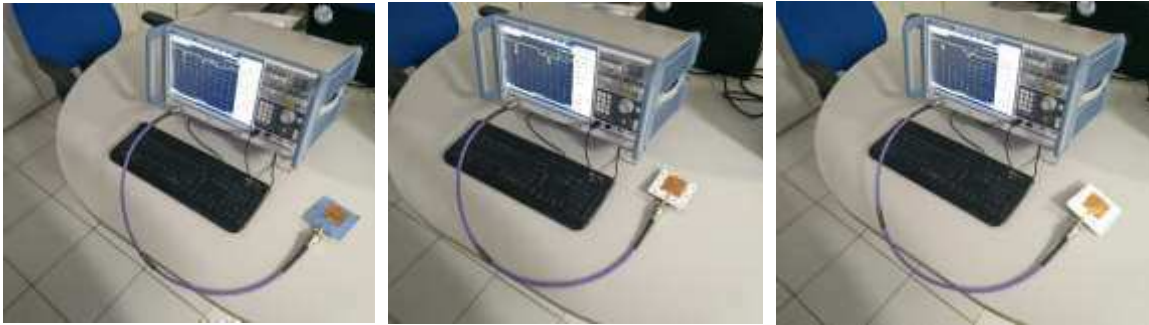
Figura 4.7. Verificação da relação experimental entre coeficiente de reflexão e frequência para as antenas construídas.
