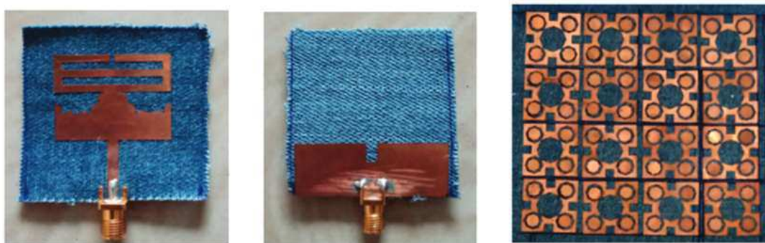
Figura 3.16. FSS e antena têxteis construídas para análise de níveis de SAR. Sugumaran, Balasubramanian e Palaniswamy (2022).
