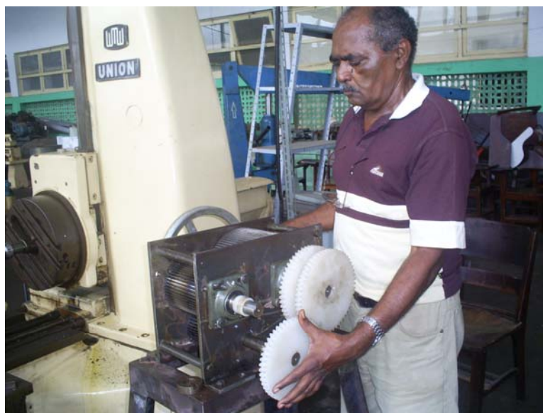
Figura 5.4 – Protótipo beta da máquina para a quebra do coco licuri
