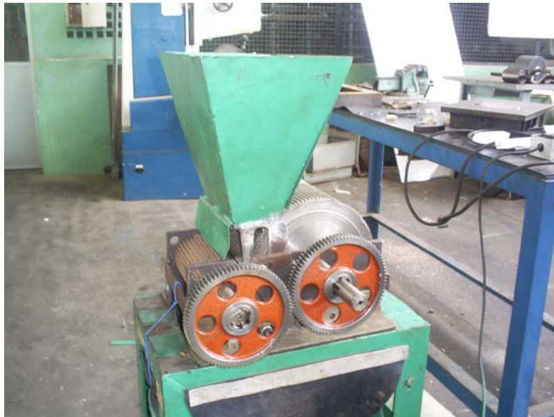
Figura 5.3 – Protótipo alfa da máquina para a quebra do coco licuri
