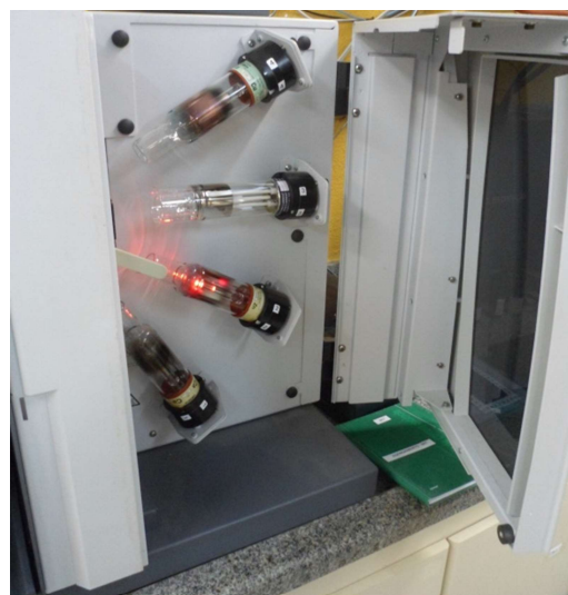
Figura 2.10 – Carrossel de lâmpadas de uso restrito no absorção atômica
