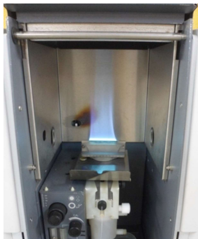
Figura 2.8 – Chama de gás acetileno gerada no queimado
