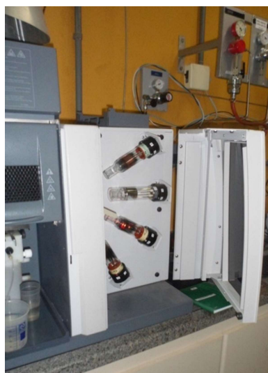
Figura 2.10 – Carrossel de lâmpadas de uso restrito no absorção atômica
